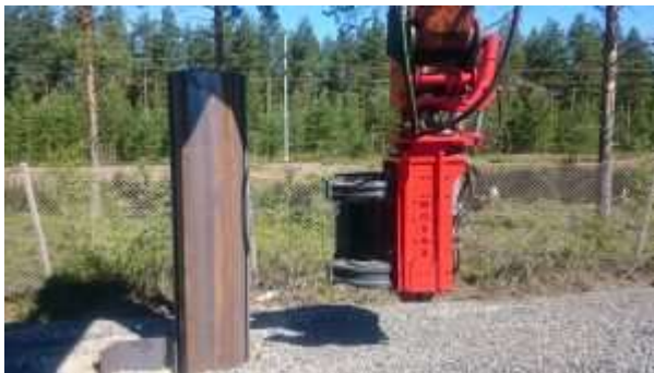
Kuva 22. Kaivinkoneeseen kiinnitettävä pontin iskijä.
