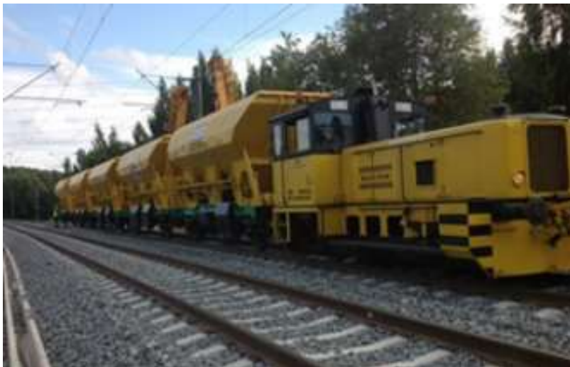
Kuva 5. Railtek Oy:n veturi Otso (5 kpl sepelivaunut ja 2 kpl avovaunut) Lähde: https://www.railtek.fi/kalusto
