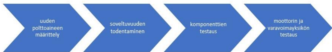
ASTM D4054 standardin mukaisen lentopolttoaineiden testaamisprosessin vaiheet
