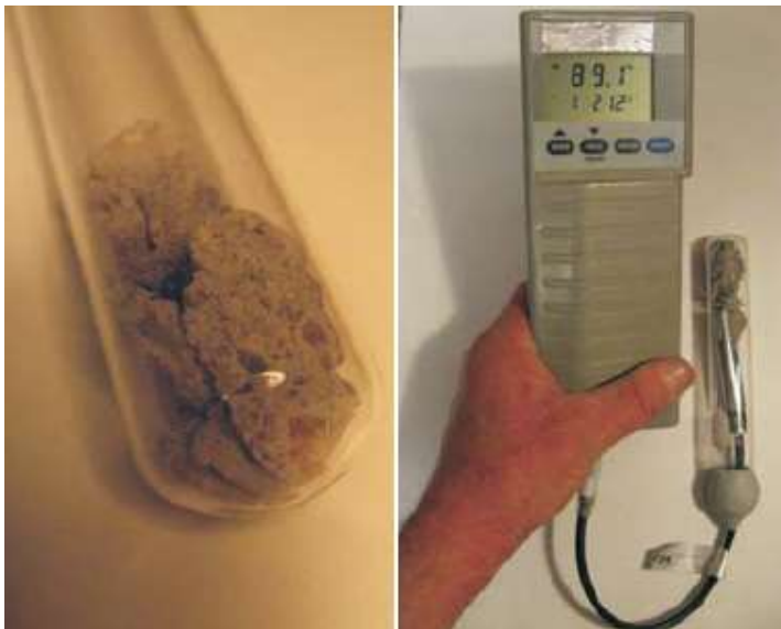
Kuva 4 Näytepala näyteputkessa ja kosteudenmittaus (RT 14-10984)
