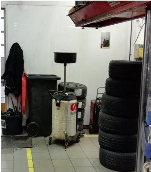
Kuva 19. Jäteöljyn keräysvaunu hallin perällä renkaiden keskellä.
