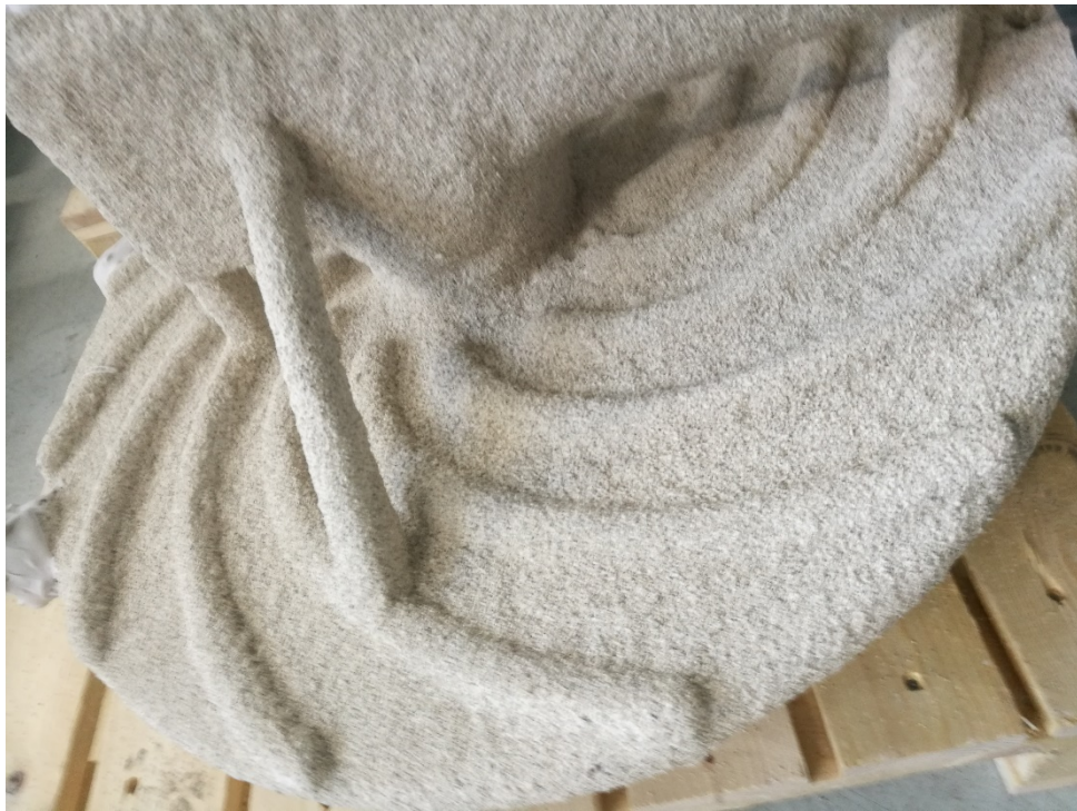
Kuva 10. Keraamikuori valmis valettavaksi.
