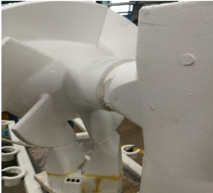
Kuva 11. Polystyreenimallin varustelua työohjeen mukaan.
