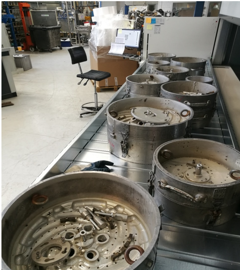
Kuva 6. Tyypillisiä Replicast-muottityökaluja varastoautomaatissa.
