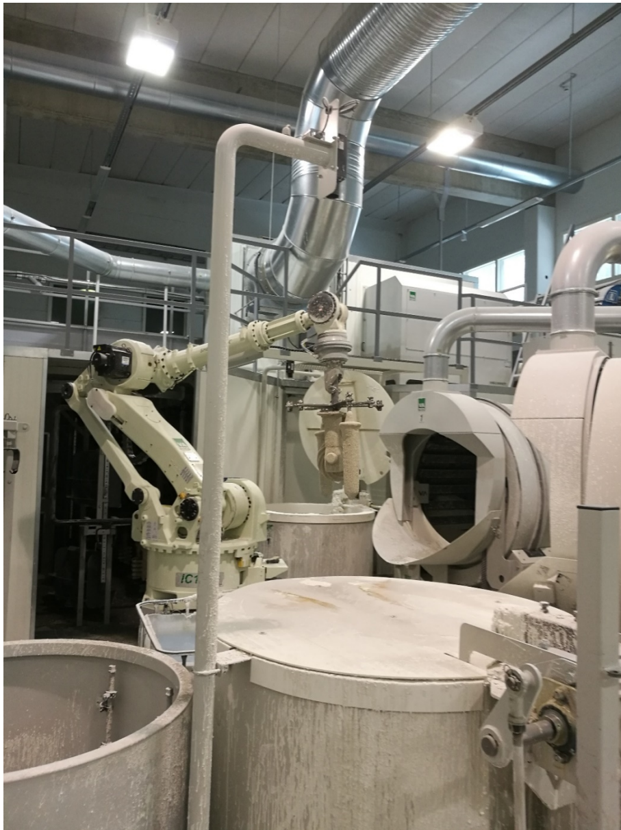
Kuva 9. Keraamikuori valmistuu kasto-osastolla robottisolussa.
