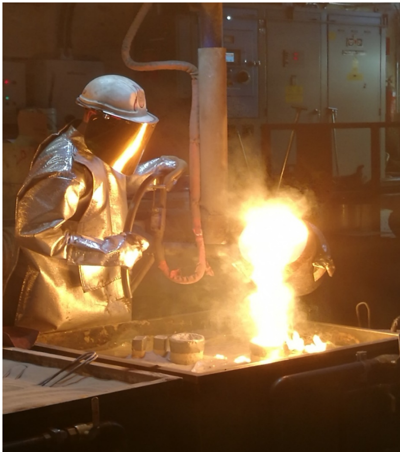
Kuva 2. Teräsvalu kaadetaan alipainekehässä olevaan keraamikuoreen.
