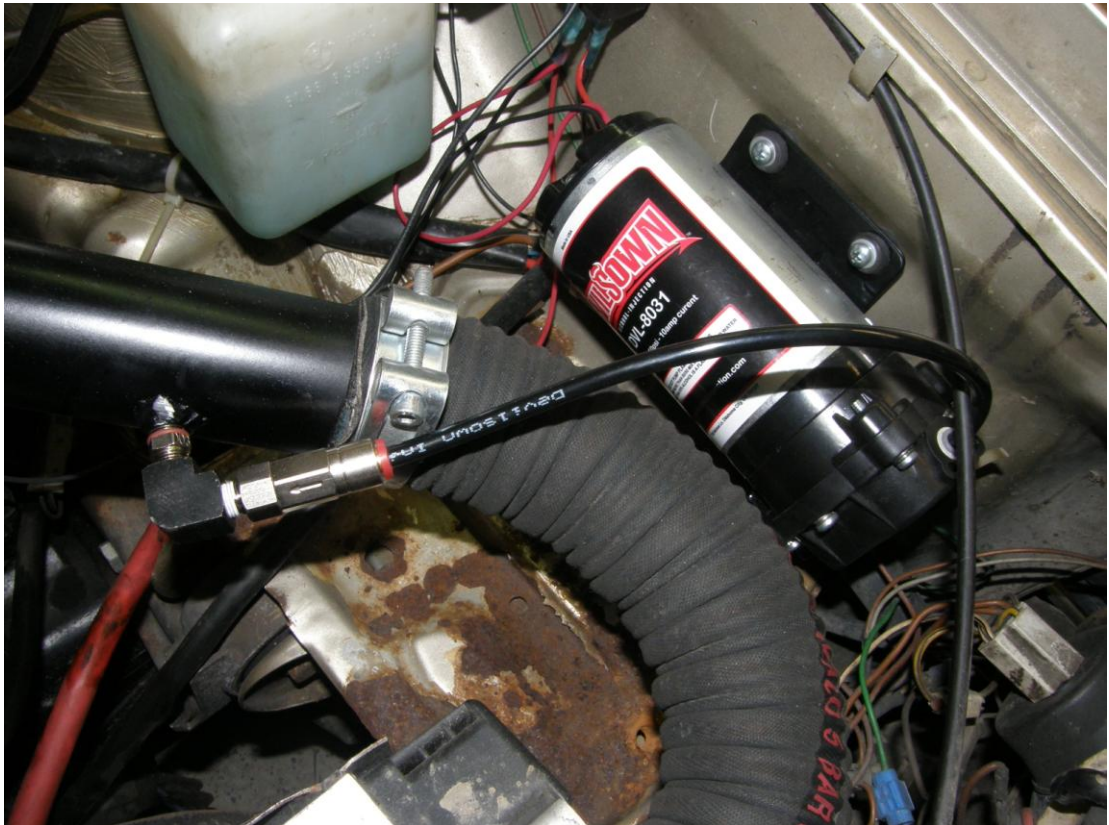
Kuvio 4. Pumpun ja suuttimen asennus.
