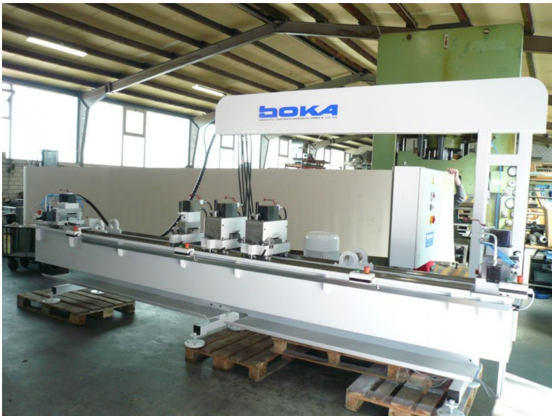
Kuva 6. Hydraulinen lävistyskone metallilevyille. Leikkurit liikkuvat lineaarijohteilla. (Joka-werkzeugbaun www-sivut)
