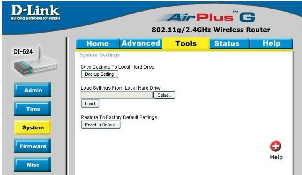
Kuvio 14: Reitittimen konfigurointitiedoston tallennus hallintakonsolilta
