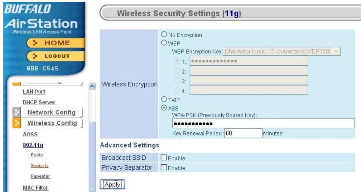
Kuvio 13: Sisäisen verkon WLAN-salasanan ja salauksen määrittäminen
