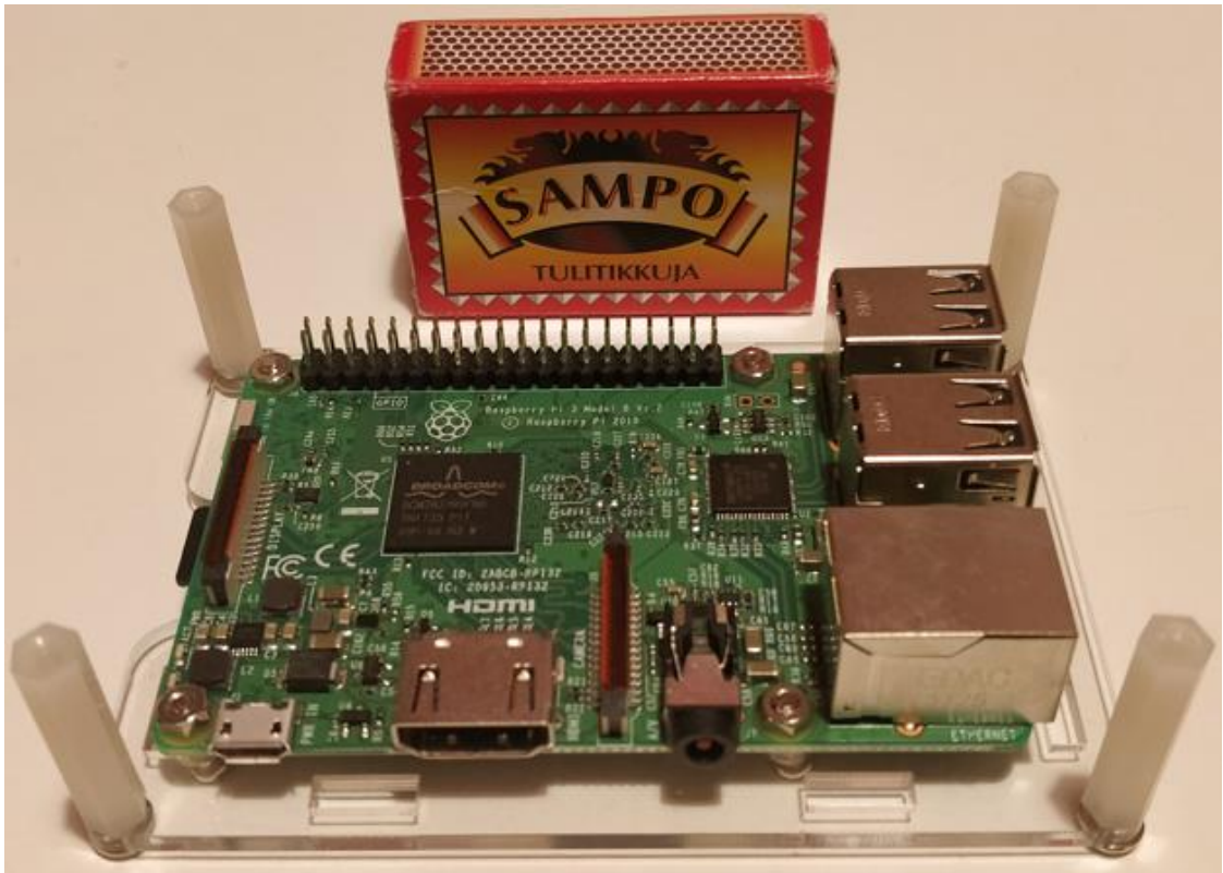
KUVA 6. Raspberry Pi 3, uudempi RPi on samankokoinen kuin vanha, versio 2
