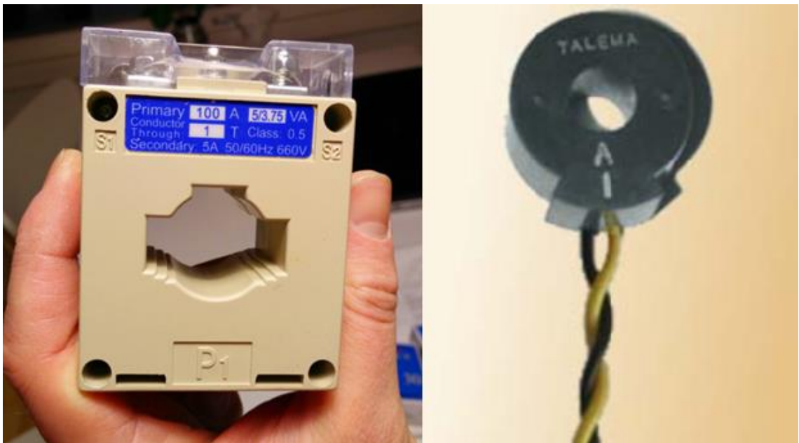
KUVA 20. Vanha virtamuunnin tyyppi ja nykyinen virtamuunnin tyyppi
