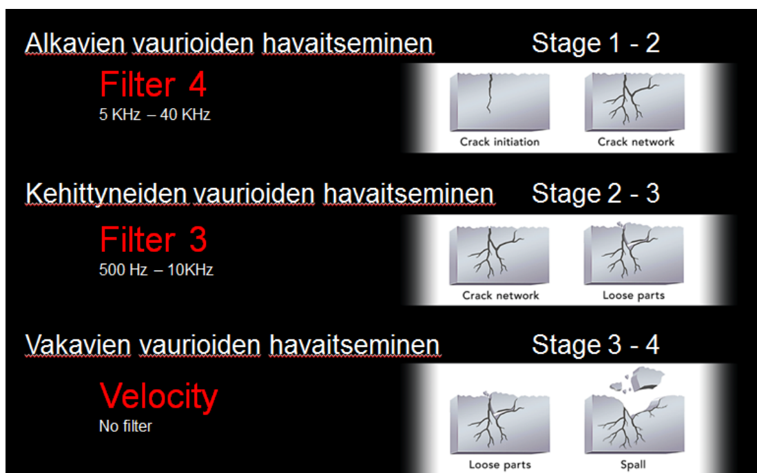
KUVA 15. Vaurioiden havaitseminen erilaisilla mittausmäärityksillä (SPM 2017.)
