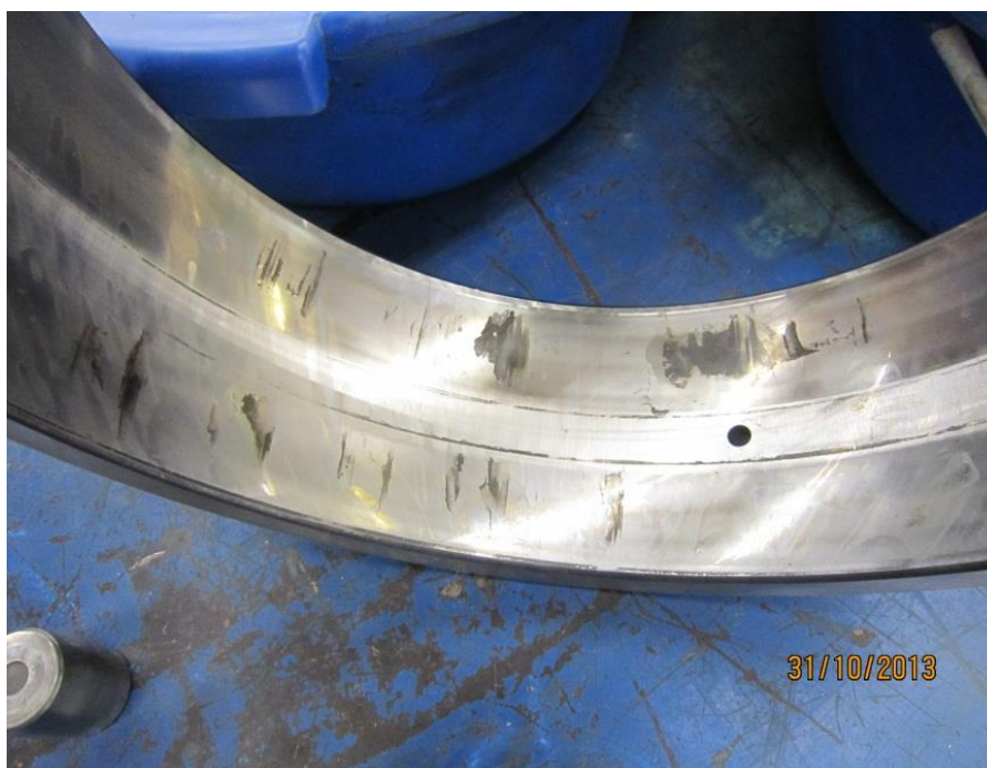
KUVA 40. Laakerin ulkokehän vauriojäljet 23144 Skf (Turunen 2013-10.)
