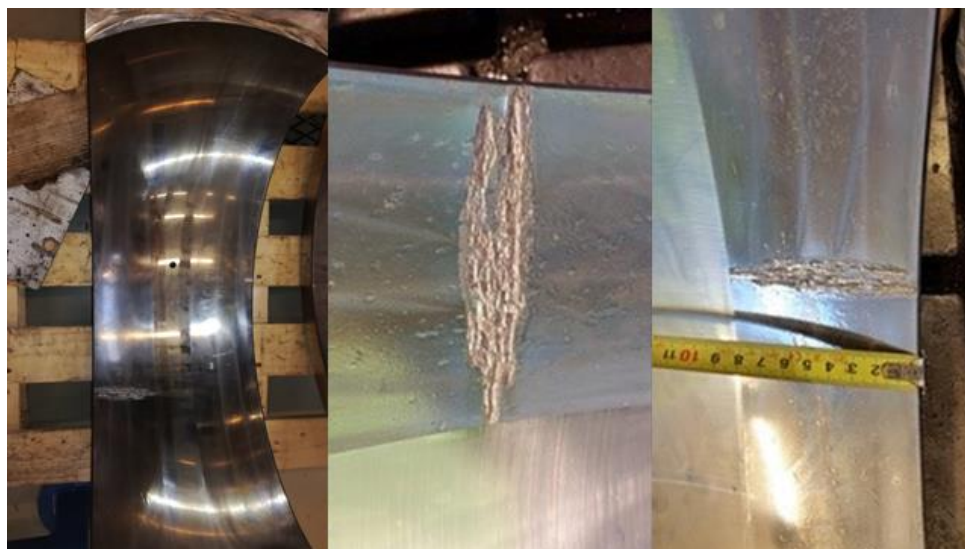
KUVA 31. Laakerin ulkokehän vauriojäljet (Laulajainen 2017-06.)
