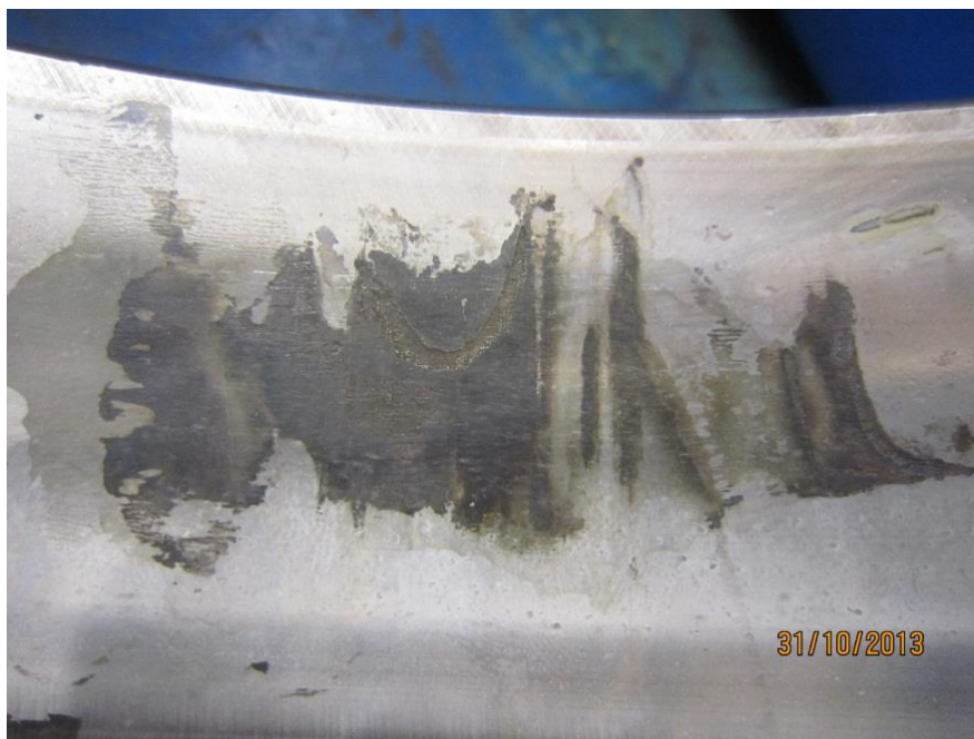
KUVA 41. Laakerin ulkokehän vauriojäljet (Turunen 2013-10.)
