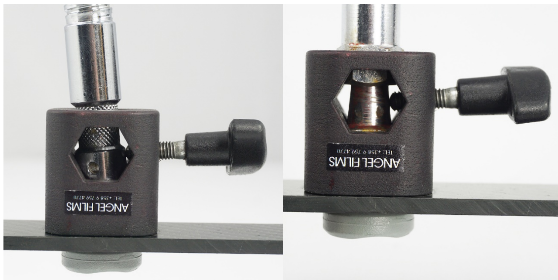
Figur 13 - En twister clamp och en snap-in spigot i version 2 av hållaren.
