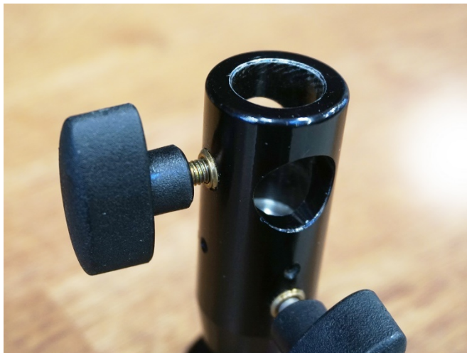
lysrör så 16 mm räcker mer än väl Figur 4 - Fäste för en 16mm spigot.
