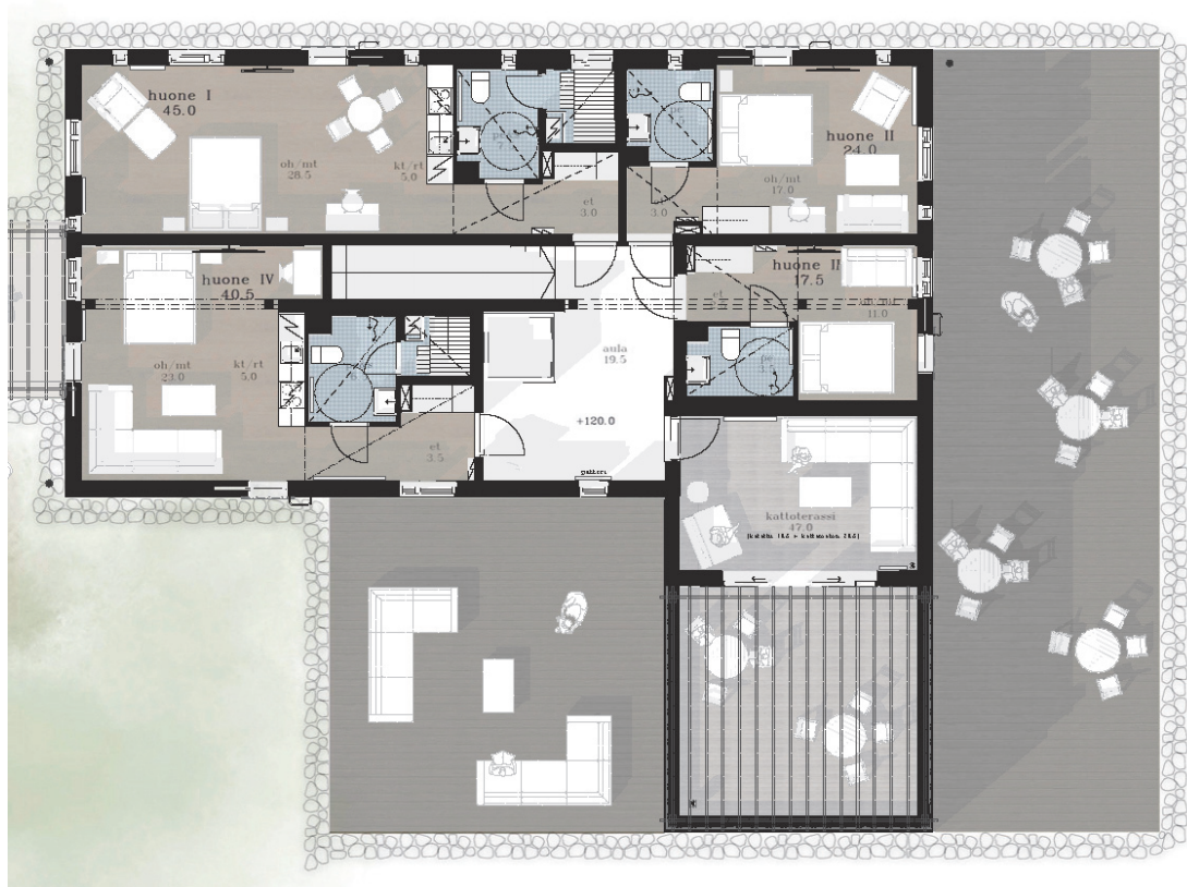
Kuva 53. Navetan 2.kerroksen tilajärjestelyt
