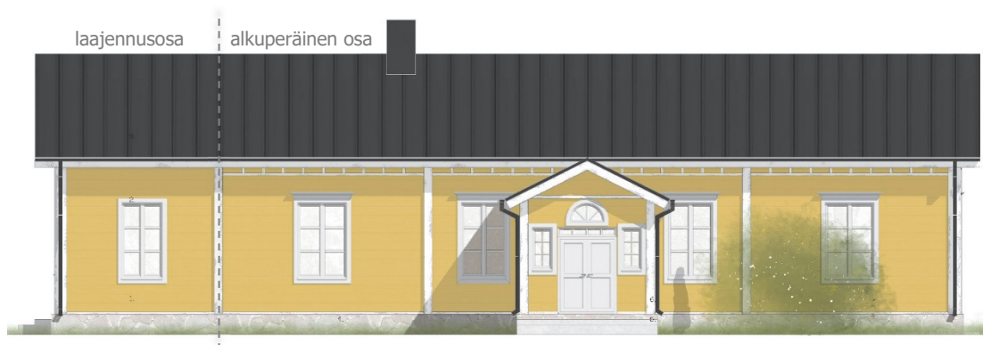
Kuva 79. Julkisivun symmetria on "rikkoutunut" laajennusosan myötä
