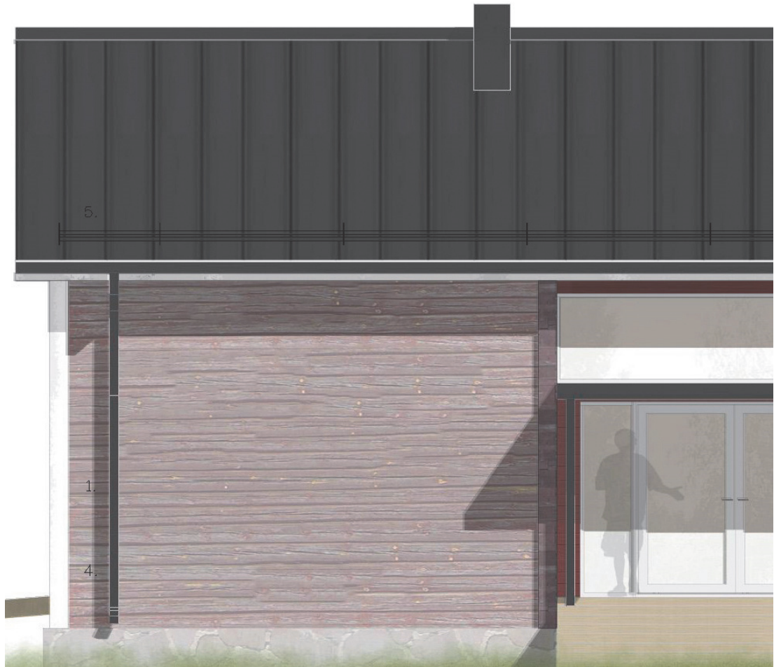
Kuva 72. Aitan punamullalla käsiteltyä hirsipintaa ei huoltomaalata, näin saadaan säilytettyä vanhan ulkoseinäpinnan patina
