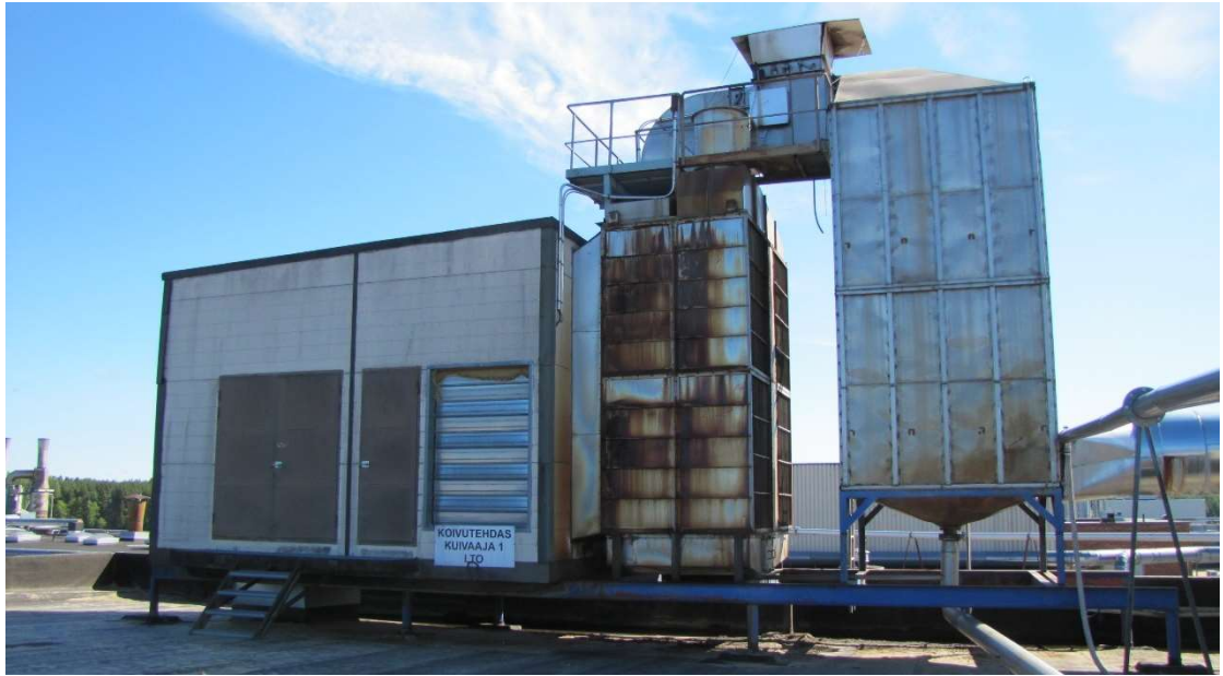
Kuvio 6. Koivuvaneritehtaan 1-kuivaajan lämmöntalteenotto
