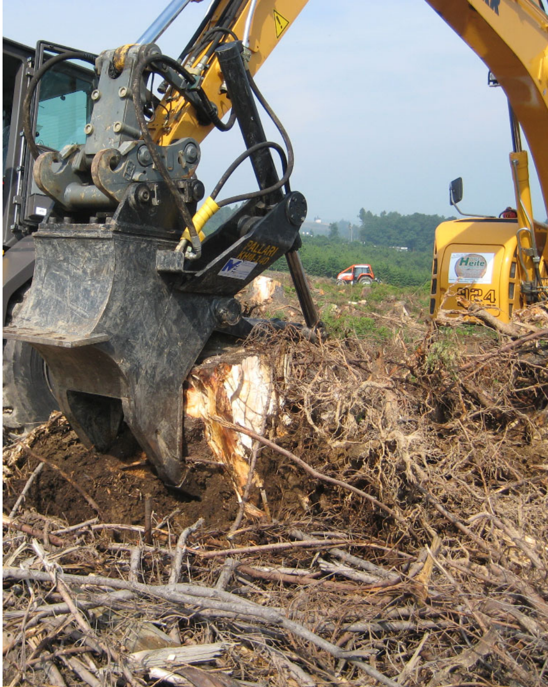
Kuva 9. KHM-140 kannon irrotuksessa (Tervolan konepaja 2018b.)
