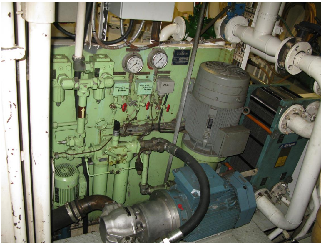
Kuva 34. Zeuksen säätölapapotkurin hydraulikkakoneikko. (Tuomas Raumanen 2018)
