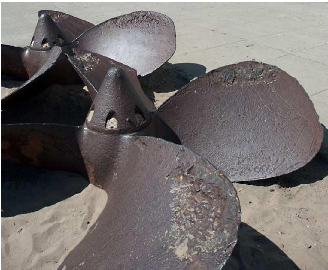
Kuva 11. Kavitaation jälkiä potkurissa. (pes-solutionsin www-sivut 2018).
