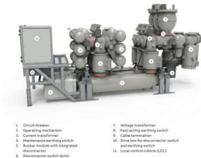
KUVA 2. 245 kV:n GIS-kojeisto (8).
