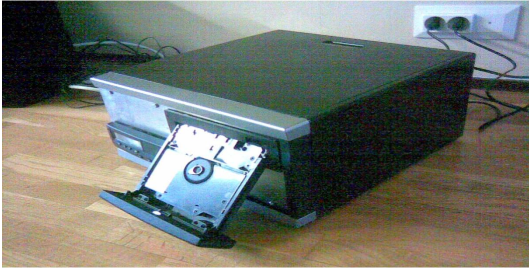
Kuva 14. Piirturi avattuna kiekon vaihtamiseksi.
