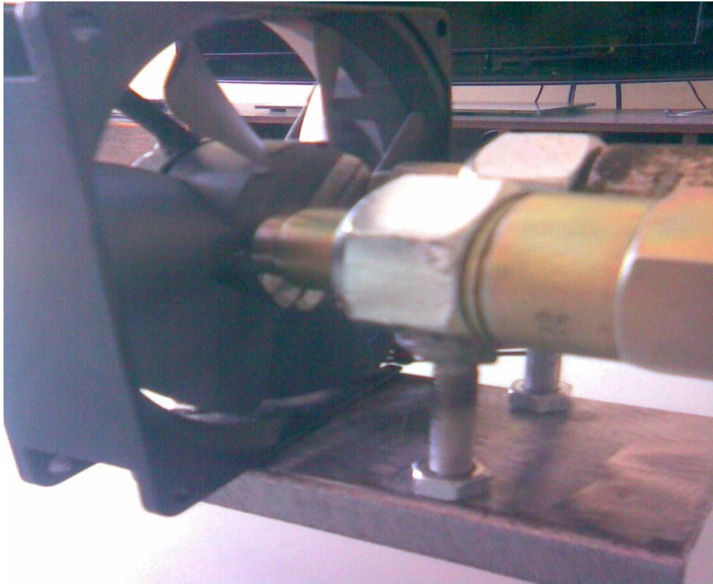
Kuva 10. Anturiteline, jossa näkyvät tuuletin ja molemmat liikeanturit.
