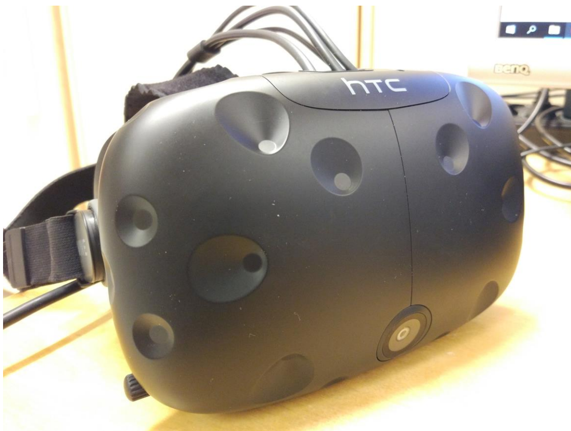
Kuva 5. Vive-virtuaaliodellisuuslasit, kuvassa vasemmalla on linssien säätörulla ja keskellä kamera.
