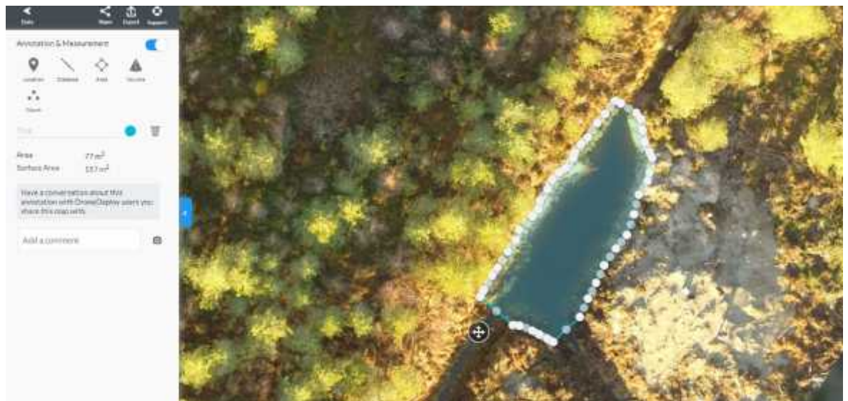
Kuva 5. Dronedeploy ohjelmalla altaan pinta-alan rajaaminen ja laskeminen. (Pyhälähti 2018.)
