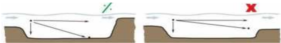
Kuva 1. Laskeutusaltaan toimintaperiaate (Joensuu 2013, 11.)
