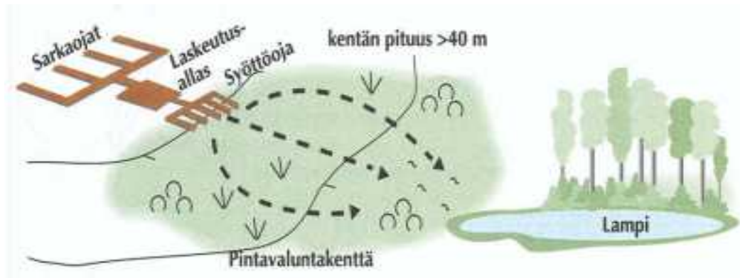
Kuva 2. Laskeutusaltaan toiminnan tehostaminen pintavalutuskentällä (Joensuu 2013, 18.)
