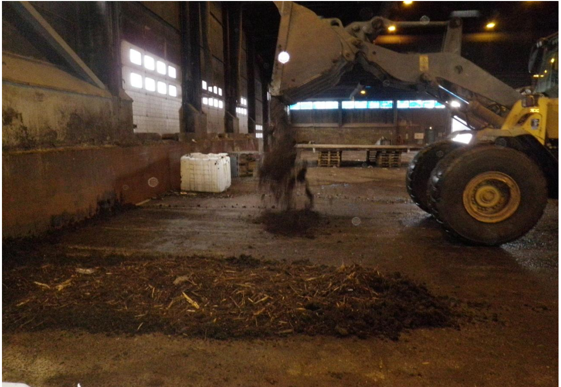
Mädätteen ja tukiaineen sekoitus tapahtui pyöräkoneella
