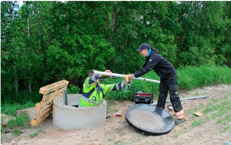
Kuva 89. Mittausantureiden asennus pohjoiseen kaivoon kesäkuussa 2016. (Kuva: Kaija Karhunen)
