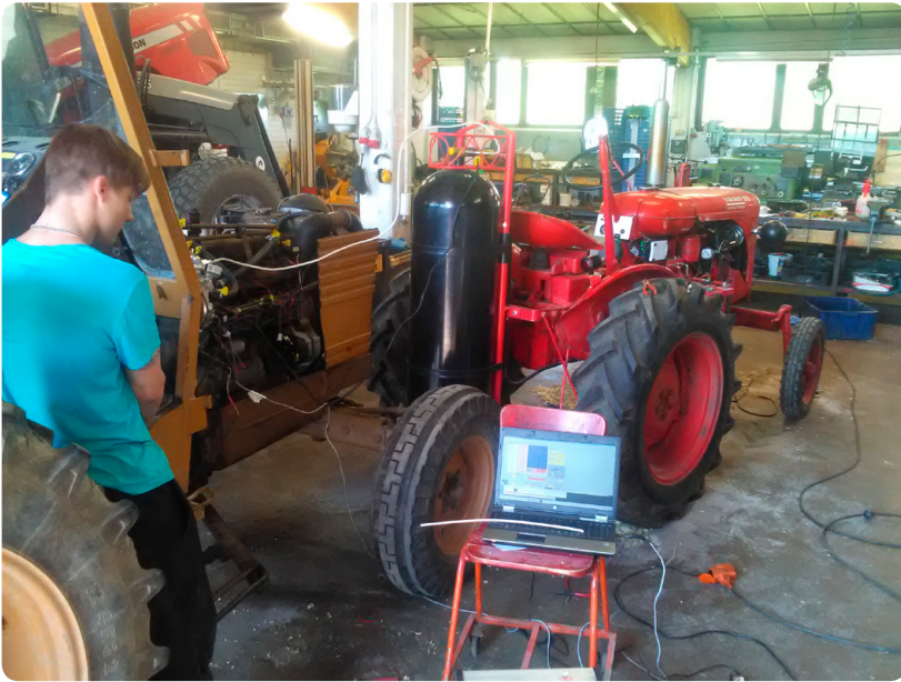
Kuva 9. Tuorlassa lopputöinä tehdyt biokaasulla toimivat traktorit. Vasemmalla Kasper Söderlundin insinööritö, jossa Valmet 502 muokattiin mekaaniseksi dual-fuel biokaasu-traktoriksi. Ja oikealla Tapani Salovaaran ja Samuli Lampon kunnostama Valmet 20, joka toimii bensiinillä ja kaasulla. (Kuva: Timo Teinilä)
