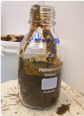
Kuva 10. Pieni, 500ml reaktoripullo, johon on laitettu tutkittavaa syötettä. AMPTS II -laitteistoon on hankittavissa myös suurempia kahden litran reaktoripulloja. (Kuva: Mikko Posio)
