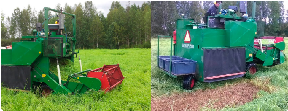
Kuva 70. Koerutujen korjuu tehtiin 5.8.2016. Satomäärityksessä käytettiin LUKE Ruuikin tutkimusaseman koerutupuimuria. (Kuva: Timo Seppälä)
