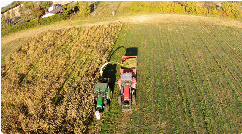
Kuva 8. Maissin korjuuta kaasulaitoksen syötteenä vuonna 2016 yksirivisellä tarkkuussilppurilla. (Kuva: Timo Teinilä)
