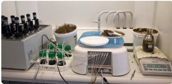
Kuva 11. Kokeen käynnistämistä Oamkin vanhemmalla AMPTS II -laitteistolla. Reaktoripullot ovat vesihauteessa (vas.) ja hiilidioksidin erottelu tapahtuu vihreäkorkkisissa pulloissa (kesk.) Vaa'alla (oik.) edellisen kuvan reaktoripullo. (Kuva: Mikko Posio)
