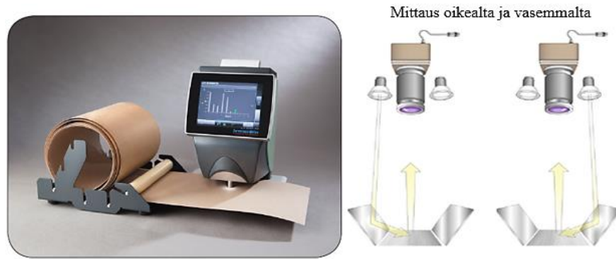
KUVA 26: L&W OptiTopo-laite (vas.) ja mittauksen periaate (oik.) (Stora Enso 2017, 23.)
