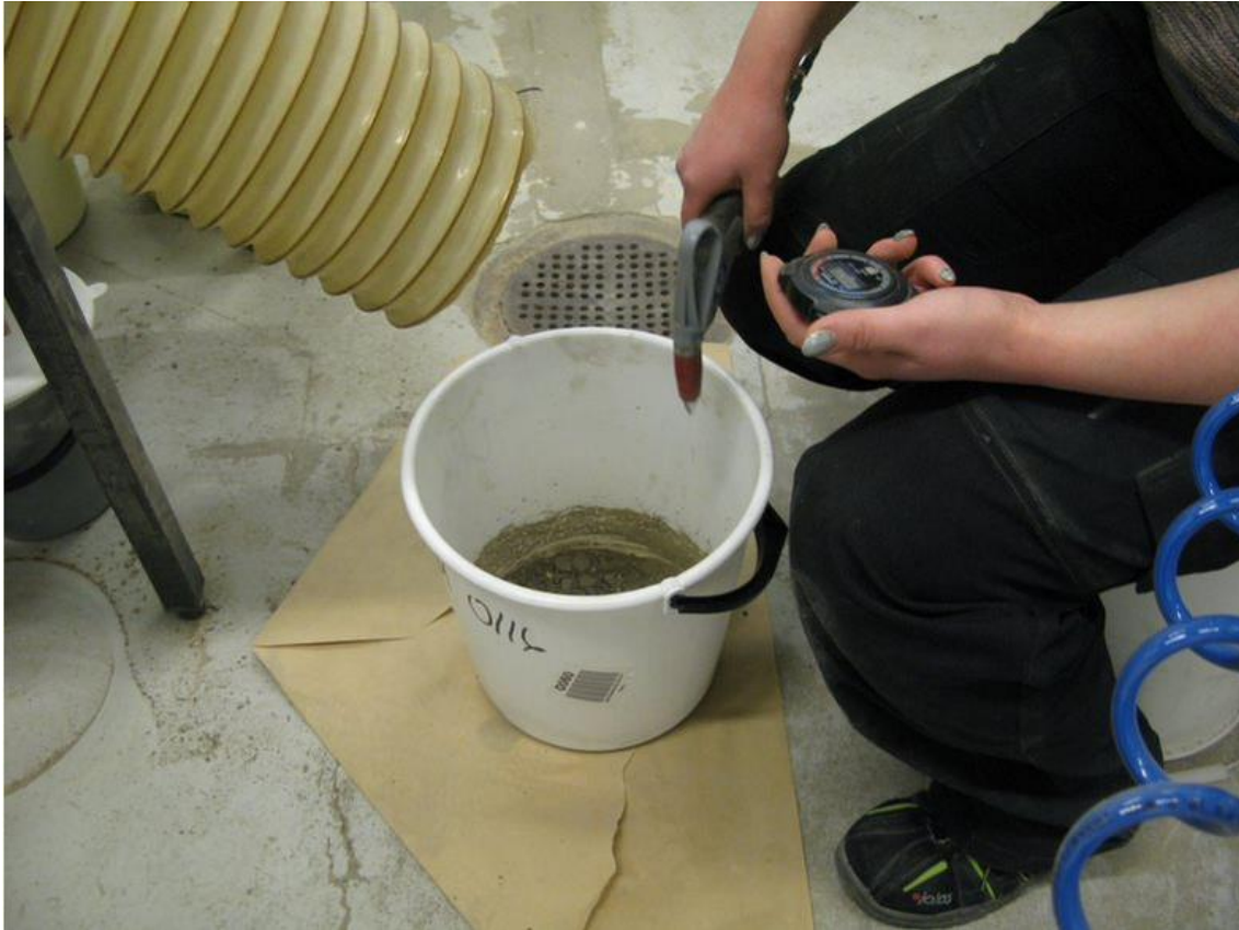
KUVA 6. Pölyävyysnäytteen puhaltamista paineilmalla
