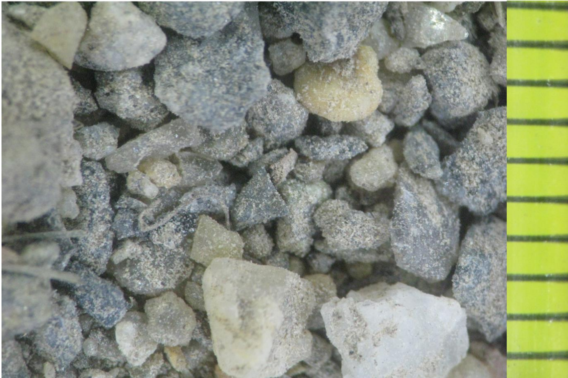
KUVA 13. Uusi 400 g + humus 3 % + vesi 60 ml. Näyte on irtonaista ja kivet ovat melko puhtaita. Mitan yksi väli on 1 mm
