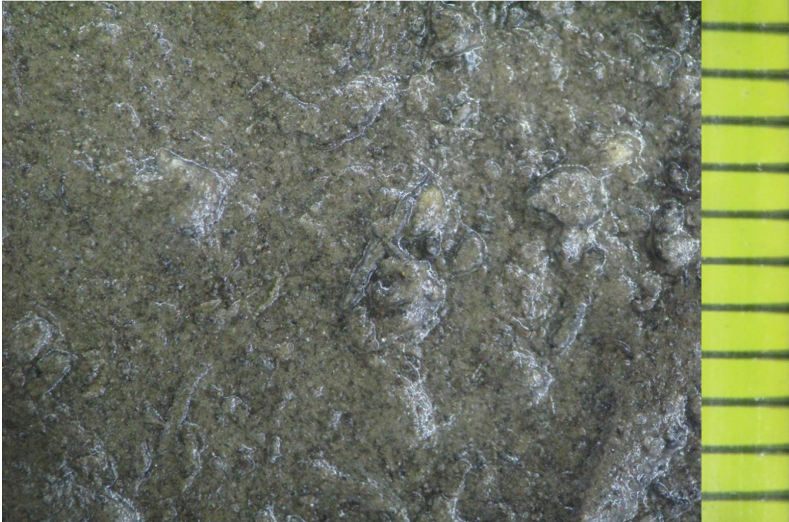
KUVA 15. Uusi 470 g + humus 3 % + vesi 70 ml, sadetuksen päätyttyä. Mitan yksi väli on 1 mm
