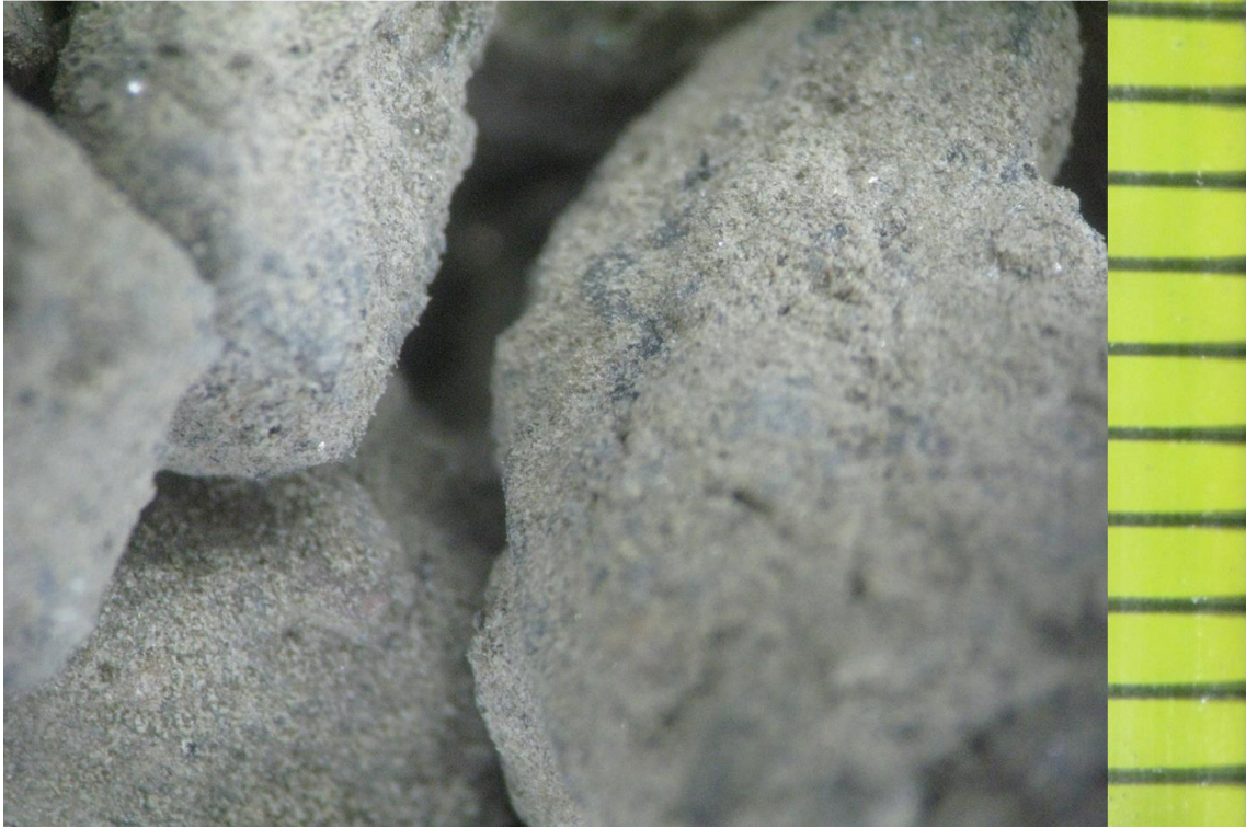
KUVA 14. Uusi 400 g + DB 30 ml + kalsiumkloridi 10 ml. Hienoaines on tiiviinä kerroksena kivien pinnassa. Mitan yksi väli on 1 mm
