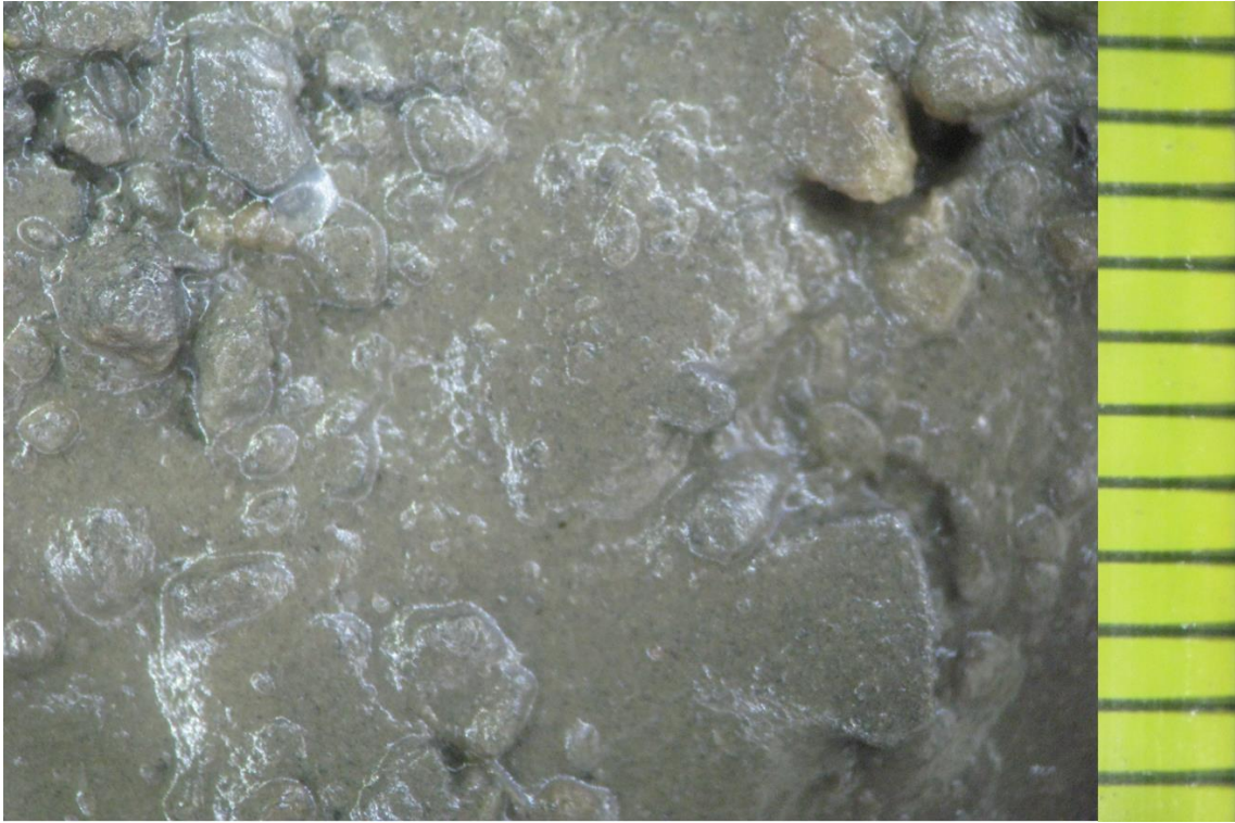
KUVA 19. Aiemmin käsitelty 470 g, sadetuksen jälkeen. Mitan yksi väli on 1 mm
