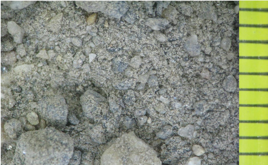
KUVA 12. Uusi 400 g + DB 30 ml + vesi 30 ml. Näyte on irtonaista, mutta hienoainesta on kiinnittynyt kivien pintaan. Mitan yksi väli on 1 mm
