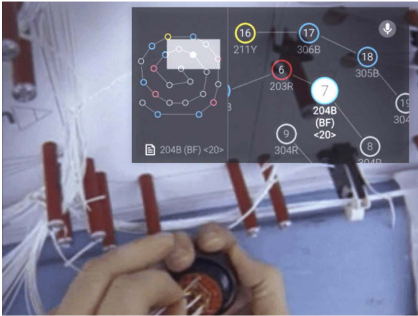
KUVA 2. Boeing työntekijä työskentelee Google Glass ja Skylight -ohjelmiston avulla. (Kuva: Sacco 2016)
