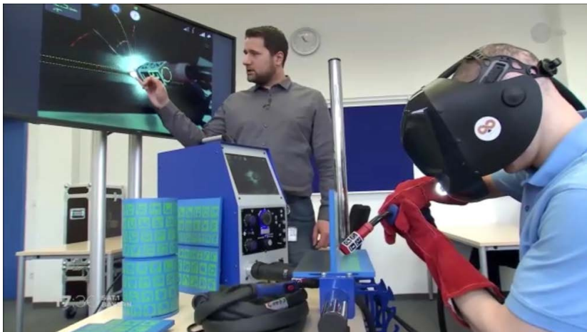
KUVA 4. Soldamatic -yritys tekee koulutuskäyttöön soveltuvia AR-tuotteita. (Kuva: Soldamatic 2017)
