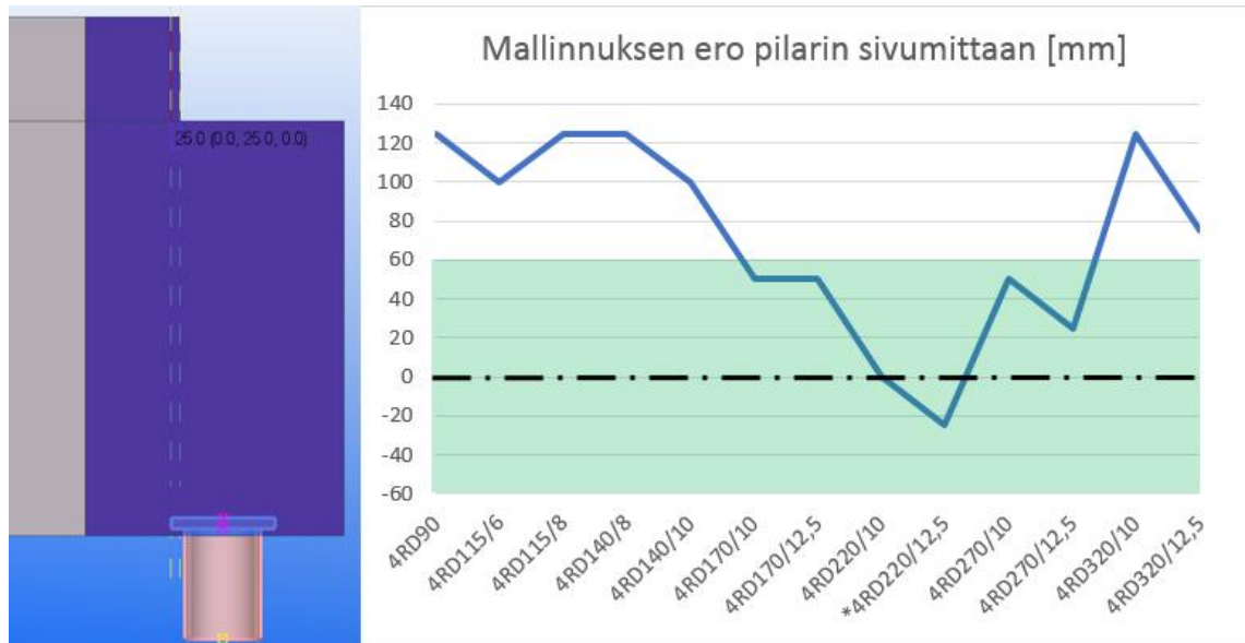
Kuva 16. Mallinnuksen ero todelliseen pilarin sivumittaan
