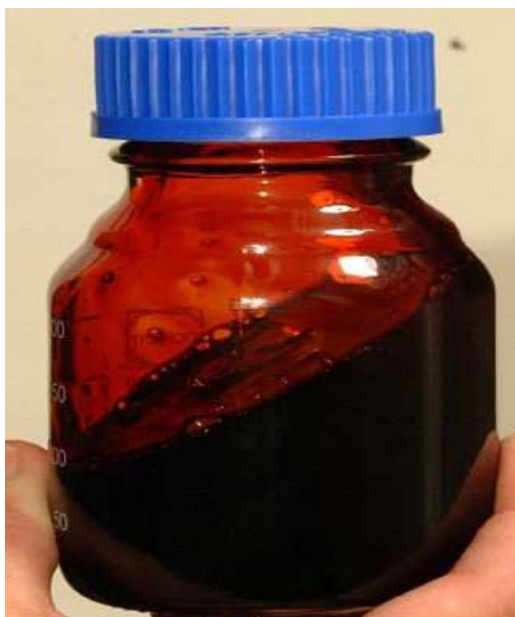
KUVA 17. Pyrolyysiöljy on olemukseltaan tervamaista (Palo 2009, 7).
