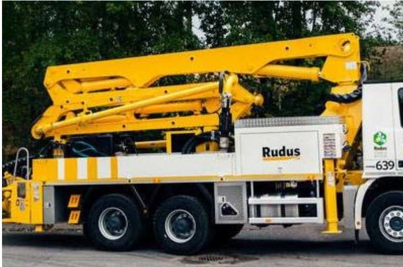
Kuva 12. Ruduksen betonipumppuauto (Rudus Oy)
