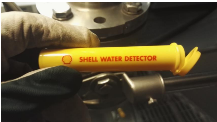
Kuva 7. Shell vesinäyttekapseli (Nurminen 2018)
