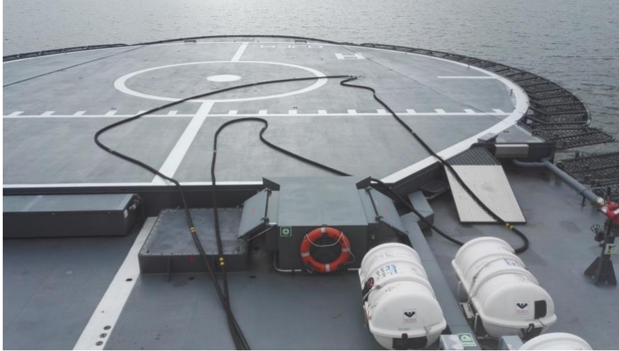
Kuva 9. Lentopetrolin kierrätys käynnissä (Nurminen 2018)
