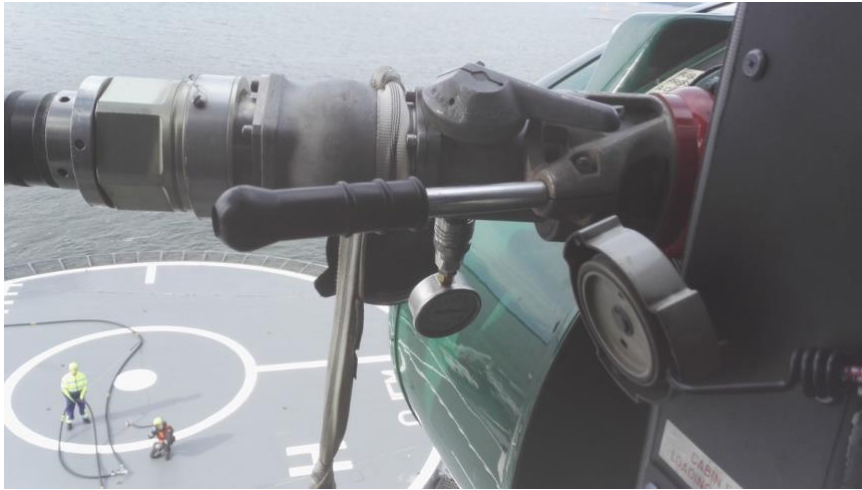
Kuva 6. Carter-liitin ja painemittari (Nurminen 2018)
