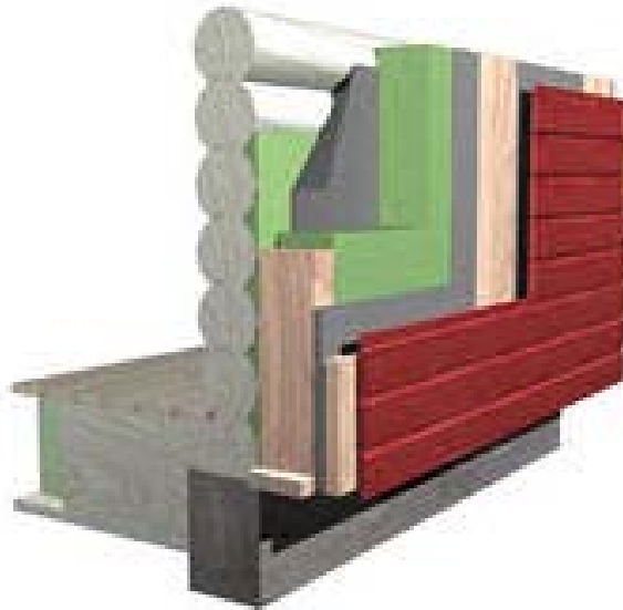
Kuvio 3: Hirsiseinä lisälämmöneristettynä ulospäin (Paroc)
