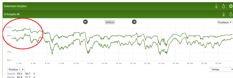
Kuva 54. Kosteaa jakso, suhteellinen kosteus korjatussa ja korjaamattomassa alapohjassa 2.8. – 4.8. (loliving, n.d.).
