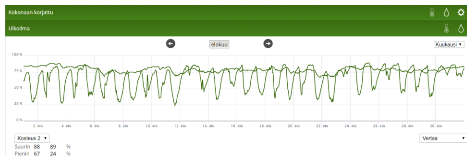
Kuva 53. Kosteaa jakso, suhteellinen kosteus ulkoilmassa ja korjatussa alapohjassa (Ioliving, n.d.).
