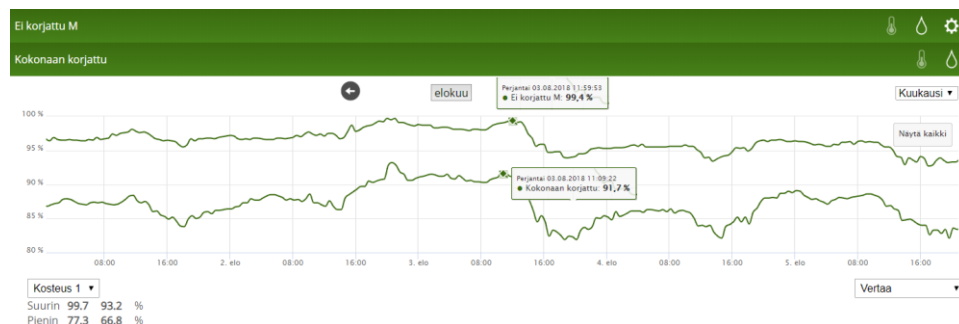
Kuva 55. Kosteaa jakso, suhteellinen kosteus korjatussa ja korjaamattomassa alapohjassa 2.8. – 4.8. (loliving, n.d.).
