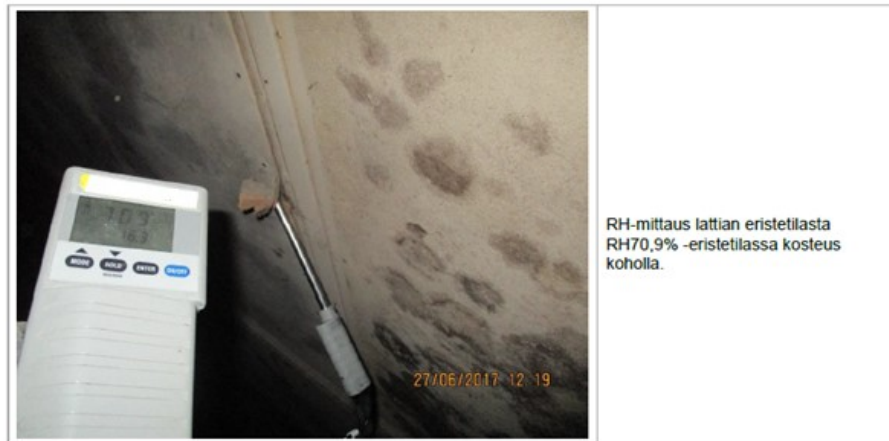
Kuva 25. Eristetilan mittaus (Materiaaliarkisto, Pulkkinen).
