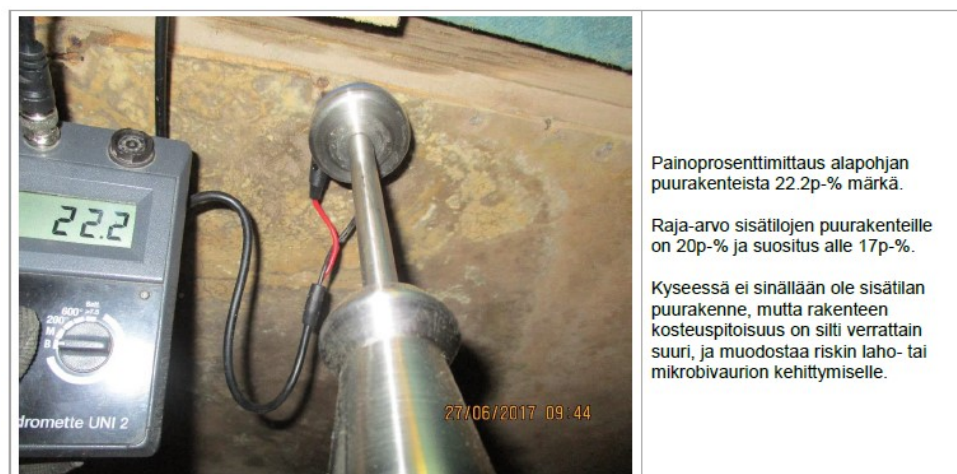
Kuva 24. Painoprosenttimittaus alapohjan materiaaleista (Materiaaliarkisto, Pulkkinen).
