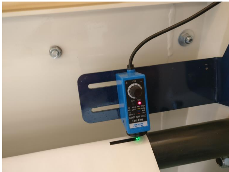
Figur 13. Placering av givare som användes i inskjutningstavlorna.
