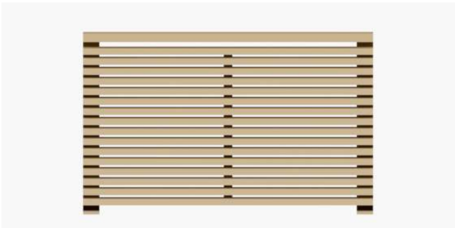
KUVA 23. Suojakaide 1.1.7 (h = 1 000 mm)
