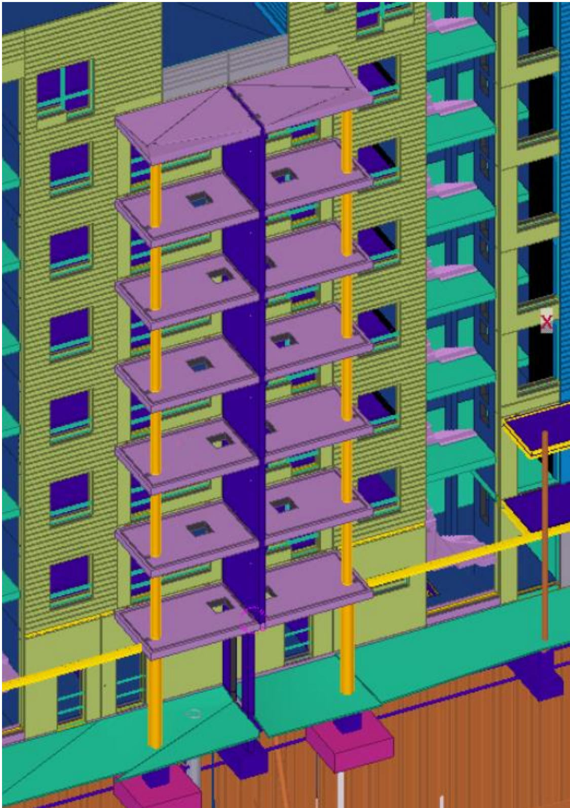
Kuva 25. Työssä tarkasteltava yhteen suuntaan kantava parvekerakenne Tekla Structures -ympäristössä
