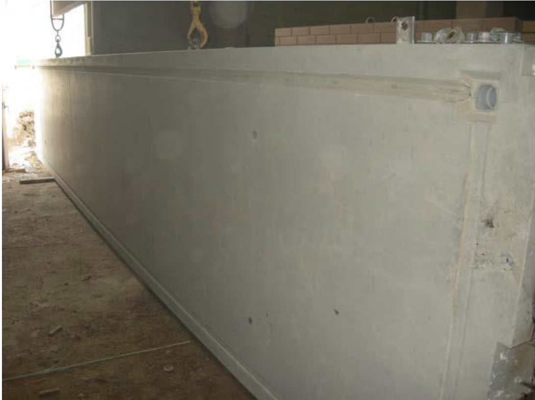
Kuva 4. Tehtaalla esijännitetty parvekelaatta (2, s. 7)
