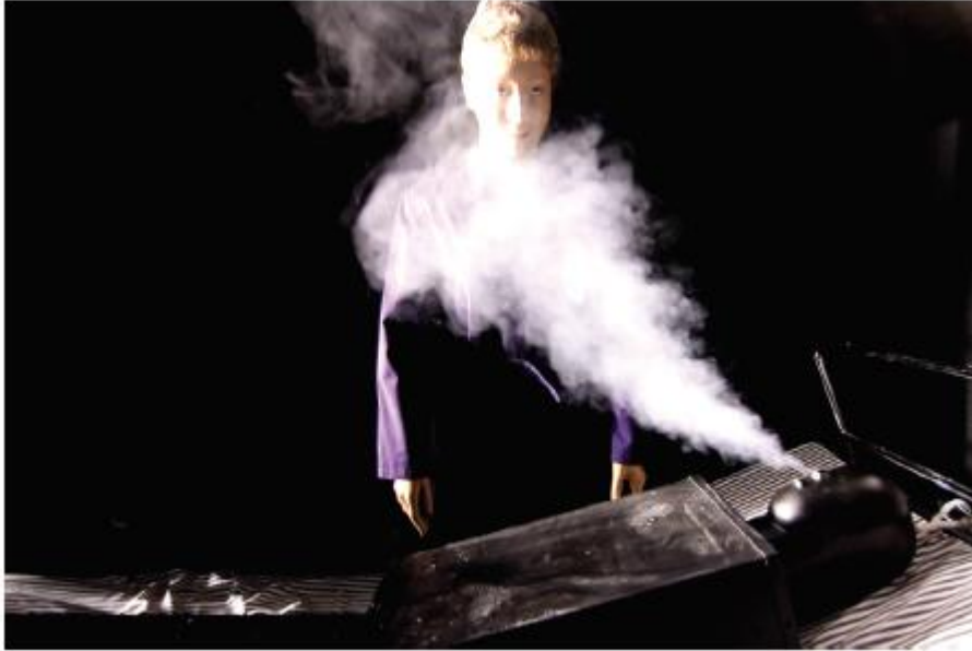
Kuva 2. Potilassängyn päällä oleva hajottaja puhaltaa ilmaa kattoa pitkin. Nukesta tuleva savu kuvaa potilaan hengitystä [12, s. 36].
