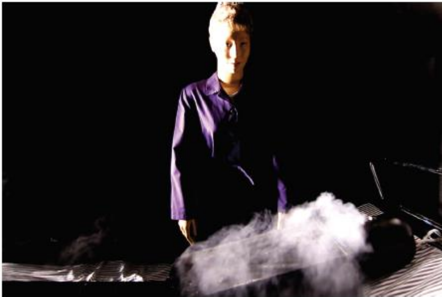
Kuva 3. Hajottaja puhaltaa ilmaa alaspäin [12, s. 36].
