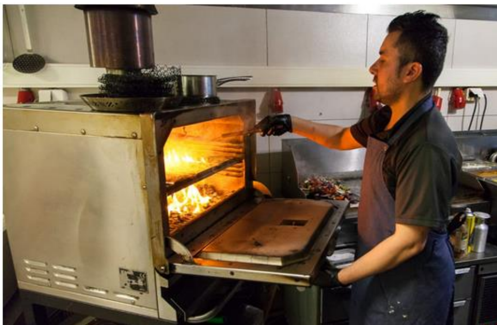
Kuva 17. Puuhiiliuunin edusta lämpenee jopa 400 °C:seen [25].
