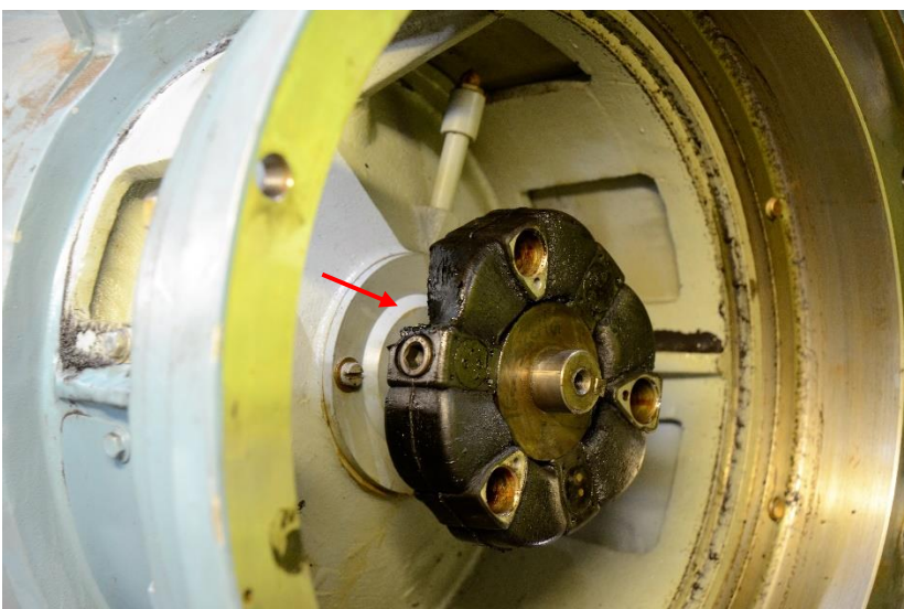
KUVA 92. Herätinkoneen rikkoontunut kytkinkumi
