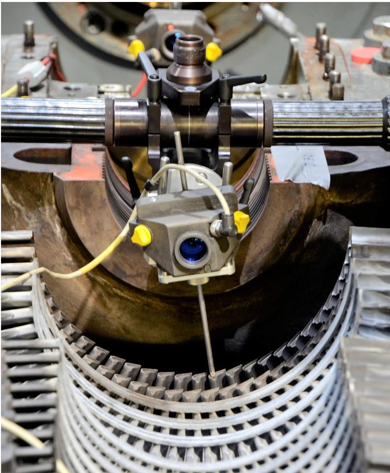
KUVA 40. Johtosiipilinjauksen tarkastaminen laserlinjauslaitteella
