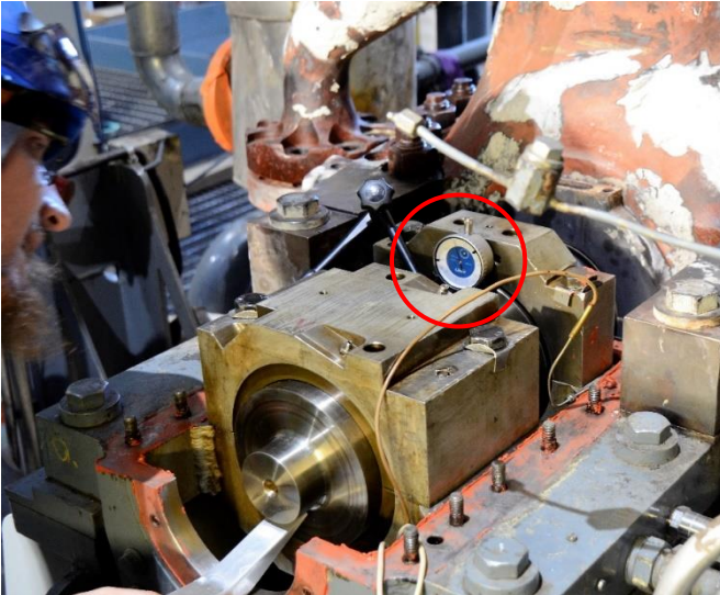
KUVA 29. Roottoriakselin pystyvälyksen mittaus
