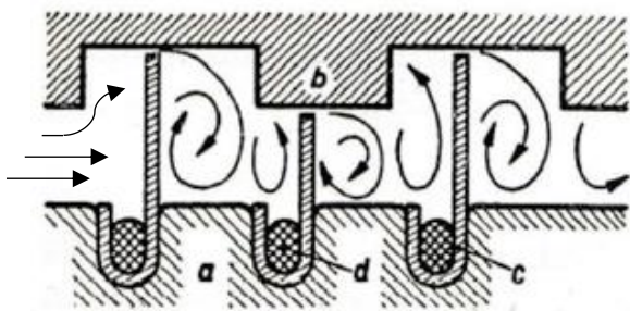
KUVA 16. Labyrinttitiivisteiden toimintaperiaate (mukaillen Kauppinen 2018)
