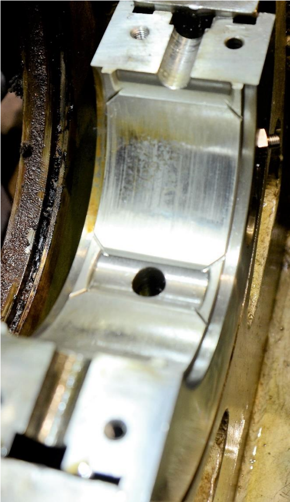
KUVA 41. Kuormitusvyöhyke havaittavissa laakerin valkometallissa
