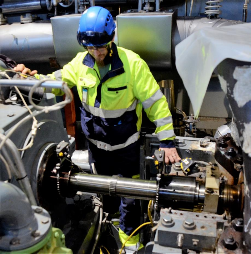
KUVA 26. Akselien linjauksen tarkastus laserlinjauslaitteella
