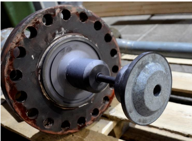
KUVA 30. Pikasulkuventtiilin keilassa kerrostumaa
