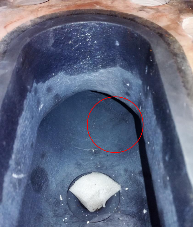
KUVA 35. Yläpesän höyrykammion särö
