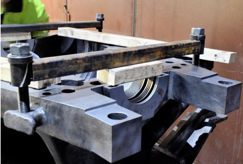
KUVA 48. Tiivistehöyrypesien puristaminen yläpesään
