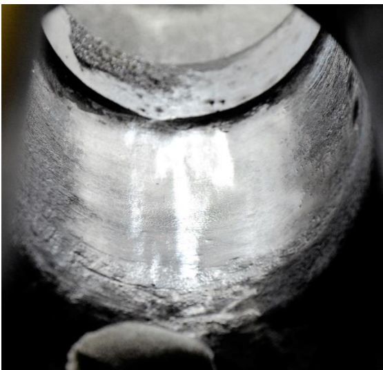
KUVA 45. Höyrykammion särö hiottu pois
