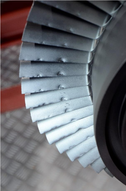
KUVA 58. Vaurioita viimeisen siipivyöhykkeen juoksusiivissä
