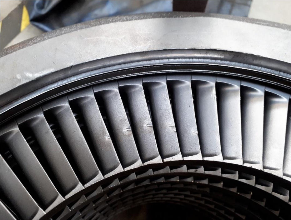
KUVA 54. Kunnostuksen aikana oli kuusi johtosiipeä vaurioitunut
