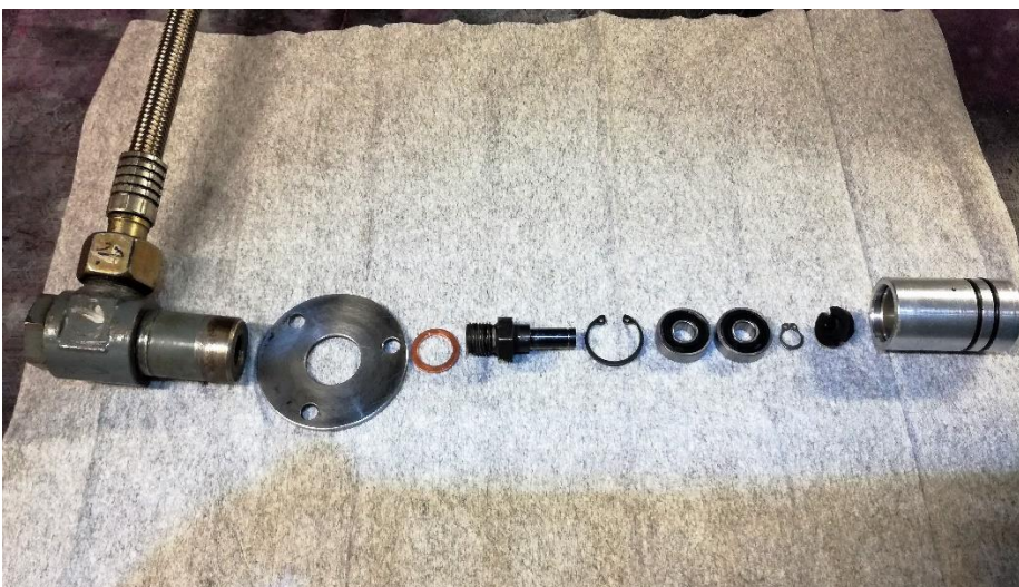
KUVA 90. SSS-kytkimen painevoitelun läpivienti purettuna
