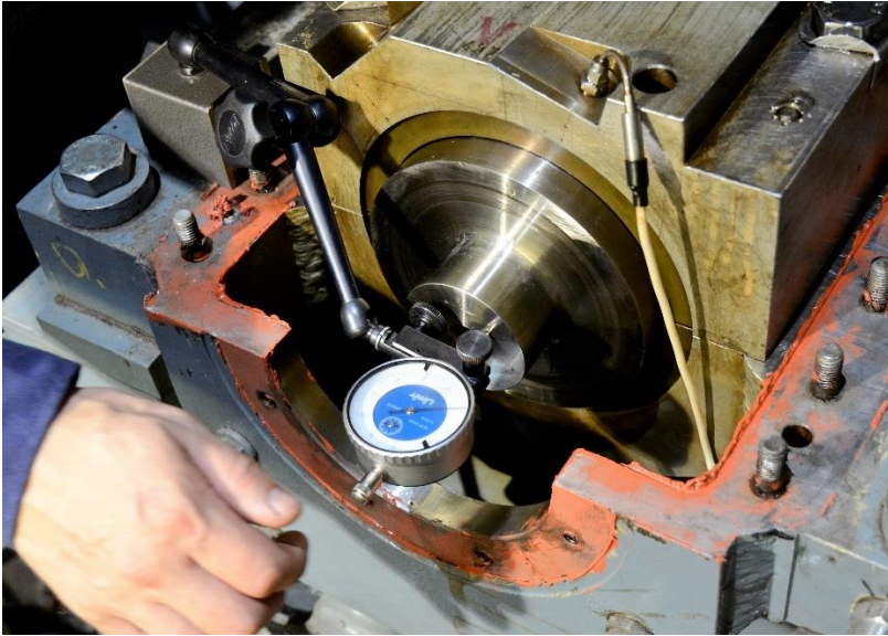
KUVA 27. Turbiiniakselin päittäisvälismittaus
