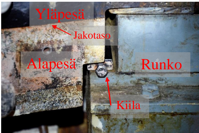
KUVA 32. Alapesä tuetaan kiilojen avulla runkoon huollon ajaksi
