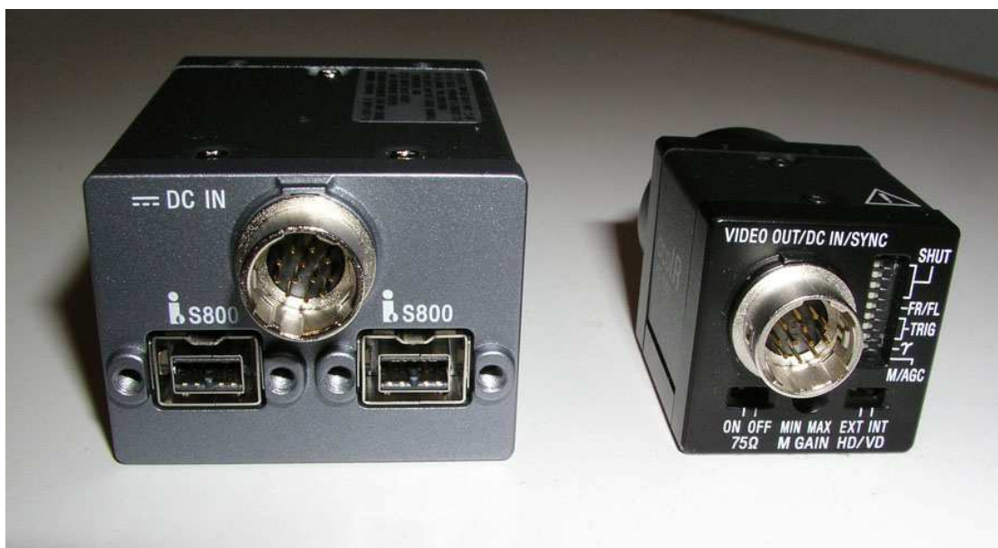
Kuva 9. Kameroiden liittännät, vasemmalla digitaalikamera ja oikealla analogiakamera.
