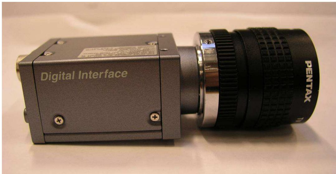
Kuva 7. Digitaalinen videokamera, jossa 25 mm optiikka kiinnitettyä.
