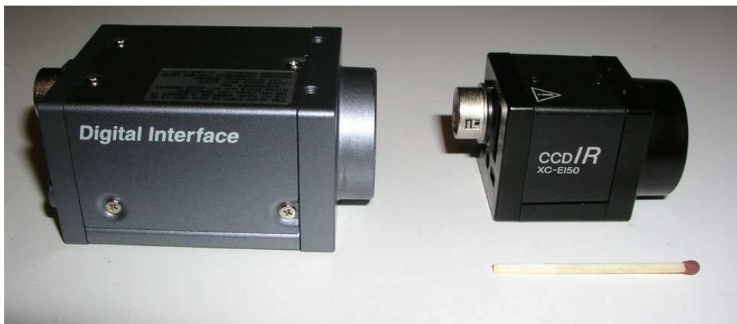
Kuva 8. Digitaalinen ja analoginen videokamera vierekkäin kokoverailua varten.
