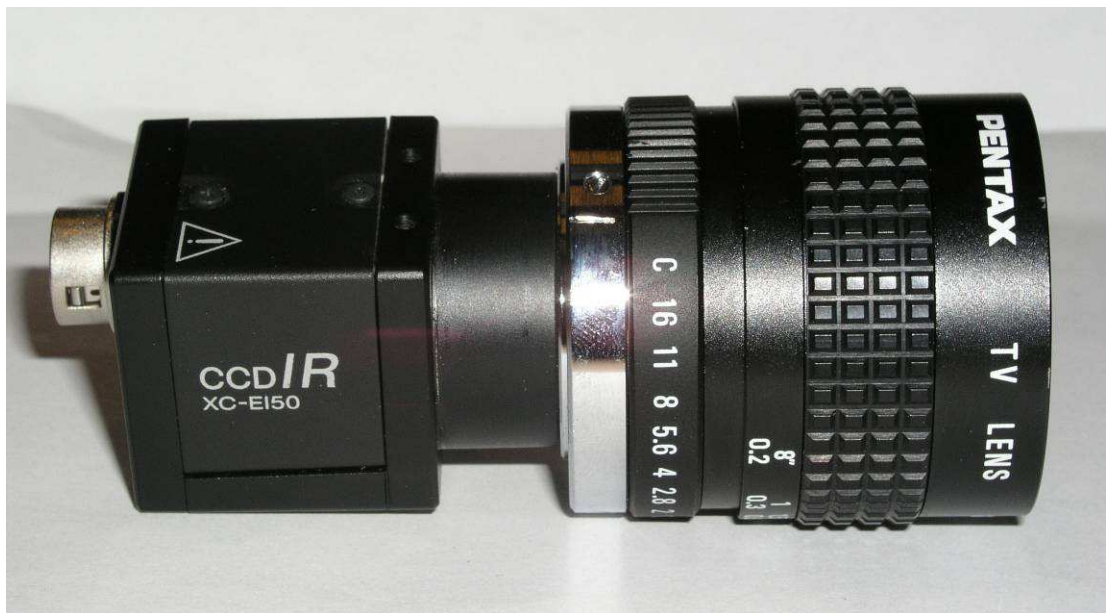
Kuva 6. Analoginen videokamera, jossa 25 mm optiikka kiinnitettyinä.
