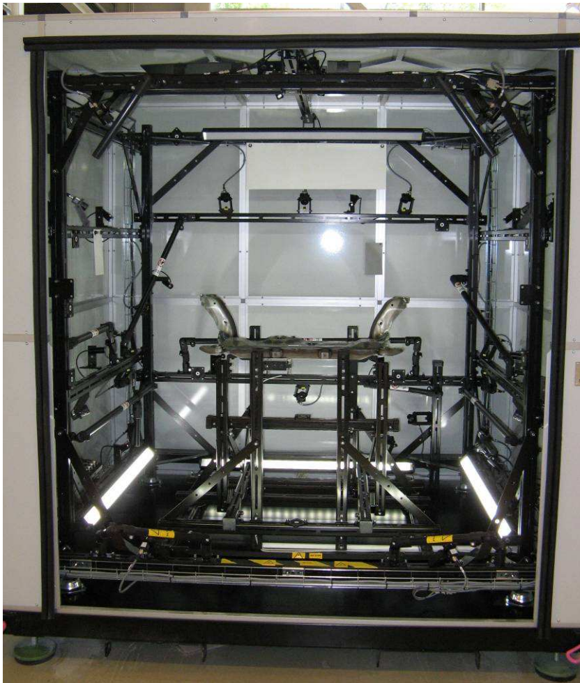
Kuva 11. Kamerarunko (musta), jonka ympärillä mittakoppi (valkoinen). Kuvassa näkyy myös kameroita ja LED-valoja kiinnitettynä kamerarunkoon sekä mitattava kappale, joka on asetettu alustan päälle.
