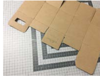
Kuva 24: Kannettavan pakkauksen rakenne levitettynä.
