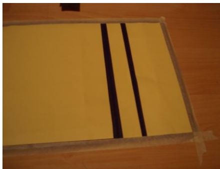
KUVA 14 Kluutin kohdistaminen teipillä
