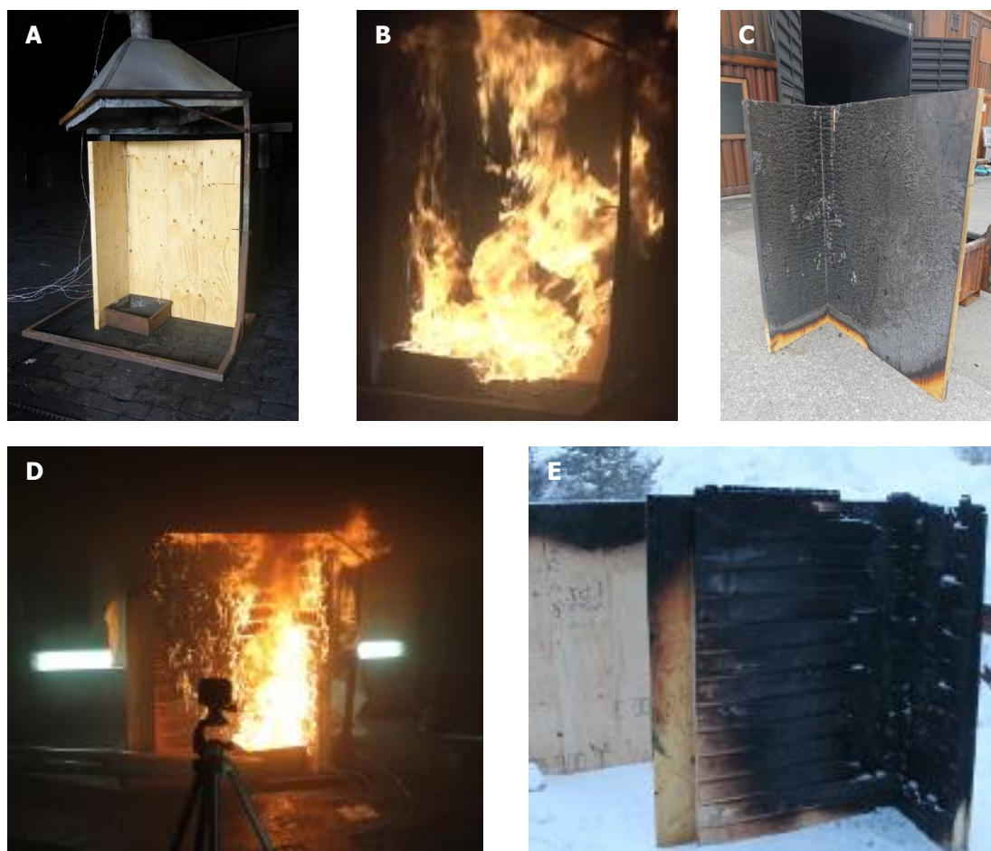
KUVA 1. Kuopion pelastusopistolla tehdyt SBI-kokeet. A – C: LVL, käsitelty kaksi kertaa Palonot-palonestokemikaalilla (levitysmäärä 200 g/m 2 ), D – E: Paneeliseinärakenne. (Kuvat: Kalle Kiviranta 8.6.2018 [A – C], 15.12.2017 [D – E].)
