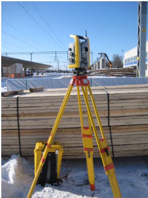
Kuva 8. Trimblen S6 -takymetri käytössä Kouvolan työmaalla
