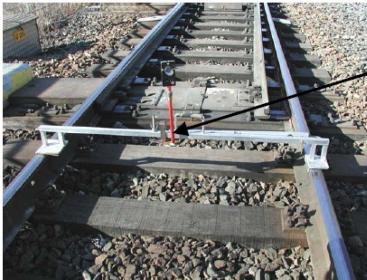
Kuva 3. Esimerkki raiteen kartoituksessa käytettävästä sapluunasta (4)
