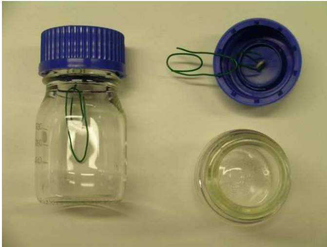
Kuva 5. Työssä käytetyn Closed container diffusion eli CCD-astian rakenne.
