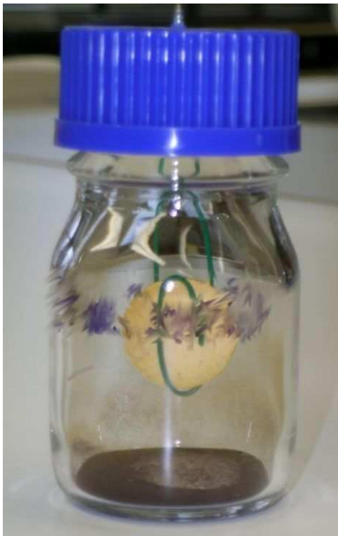
Kuva 6. Closed container diffusion eli CCD-astia keräyksessä. DNPH-suodatin roikkuu PVC:llä päällystetyn rautalankatelineen varassa. Astiaan kirjoitettu teksti on häivytetty jälkikäteen kuvanmuokkausohjelmalla.
