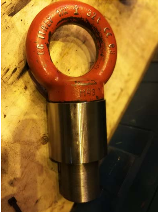
Kuva 12. Pitkällä hienokierteellä oleva nostosilmukka.
