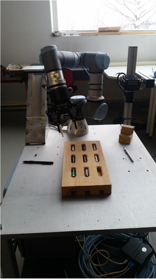
KUVA 9. Kuva varsinaisesta työpisteestä. Kuvassa näkyy myös UR3, OptoForcen voima-anturi, sekä Robotiq 85 2-Finger gripper asennettuna paikalleen
