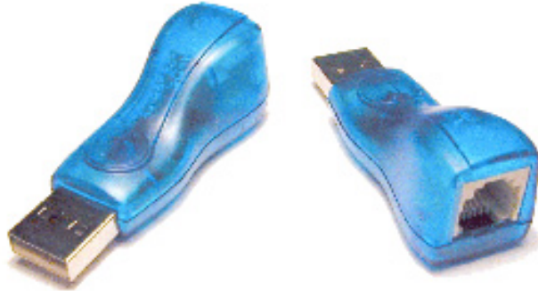
Kuva 3. USB-1-Wire -sovitin DS9490R. [5]
