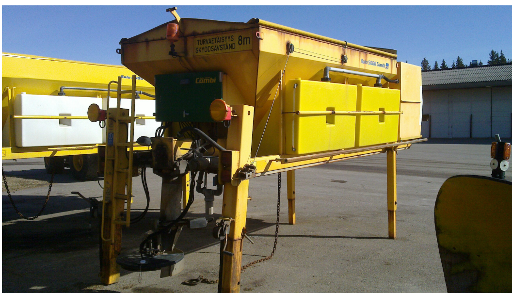
Kuva 6. Destian suolausautomaatilla voi levittää joko liuosta tai kostutettua suolaa.
