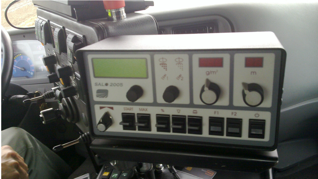
Kuva 11. Suolausautomaatin elektronisella ohjaimella voidaan säätää haluttu grammamäärä suolaa/m 2 .
