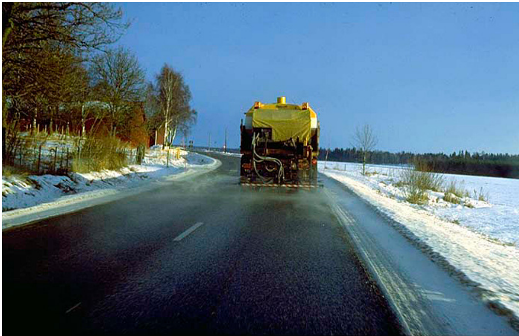
Kuva 4. Liuossuolauksella poistetaan tai estetään ohut musta jää hoitoluokan I tieltä (Tiehallinto 2010).
