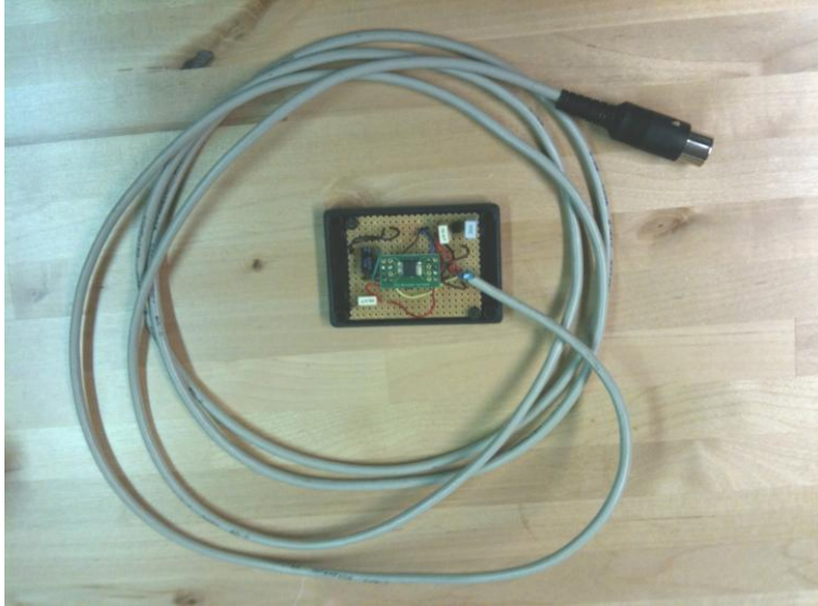
Kuva 11.2. Kulmatietoanturi piirilevyllä kotelon sisällä.
