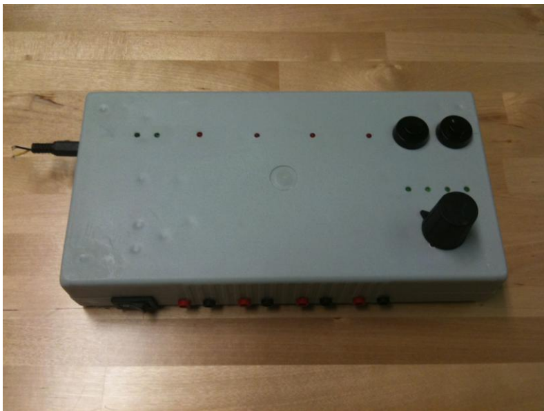
Kuva 11.5. FES-ohjausyksikön kotelointi valmiina.
