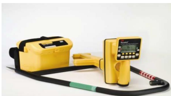
KUVA 20. Putken ja kaapelinhakulaite 3M Dynatel 2573E (15)
