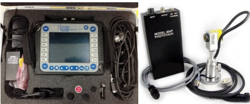
KUVA 9. Emerson CSi 2130 -kunnonvalvonta-/diagnostiikkalaite ja CSi 404B Phototach -infrapuna-anturi (Emerson)
