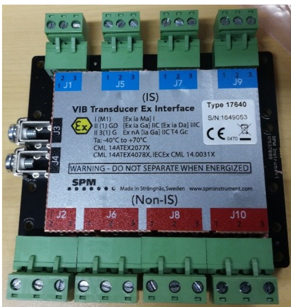
KUVA 11. SPM VIB Transducer Ex Interface 17640 -kiihtyvyyssanturi-barrieri
