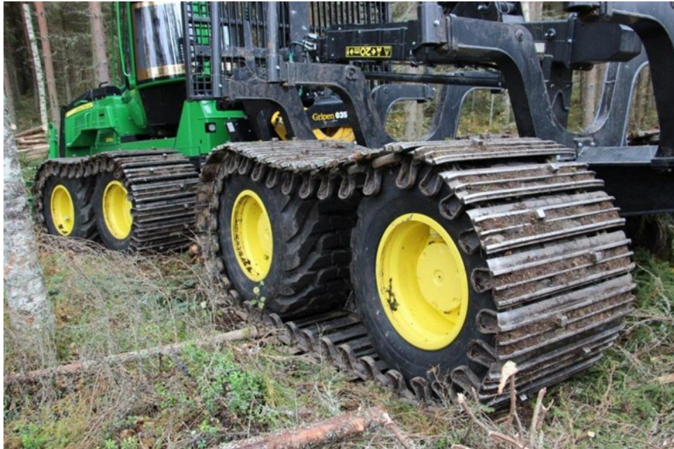
Kuva 6. Koneosapalvelu Oy:n KOPA kantavat telat kuormatraktorissa. (Koneosapalvelu, 9.1.2019)
