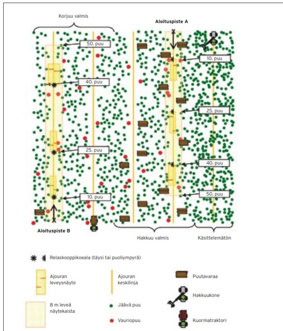
Kuva 5. Metsätehon Online-mittausmenetelmän periaatepiirros käynnissä olevan työmaan mittausrutiinista. (Metsäteho Oy, 2003)
