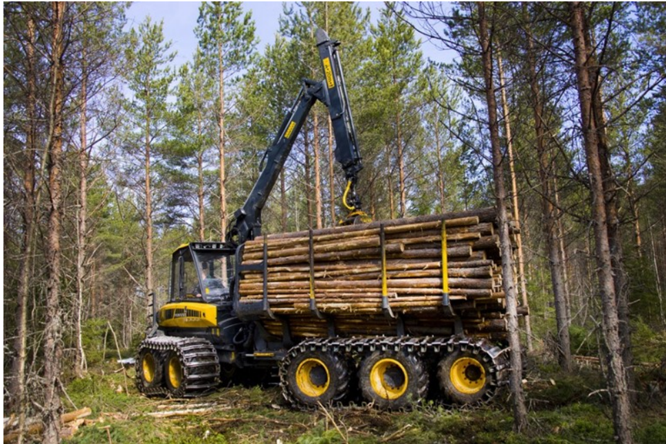
Kuva 7. Ponsse Wisent 10w kuormatraktori, jossa lisäakseli takarungossa kantavuuden parantamiseksi. (Ponsse, 9.1.2019)
